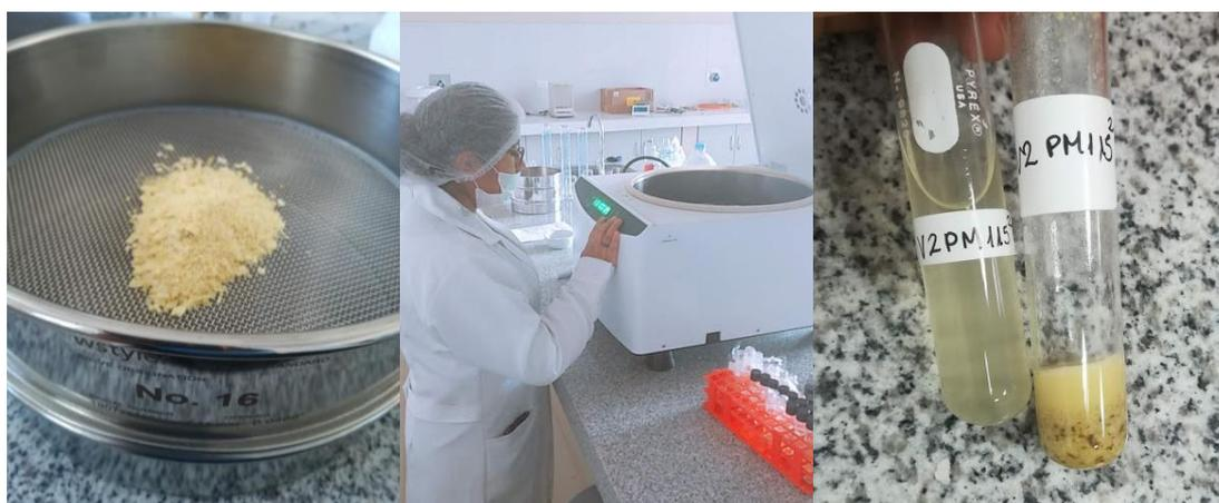
**Figura 48: Extracción de alcaloides-preparación de la muestra centrifugado-neutralización.**
