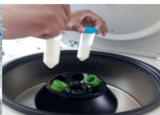
Figura 20. Colocación de los tubos
