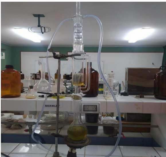
Figura 15: Extracción de grasa de las muestras
