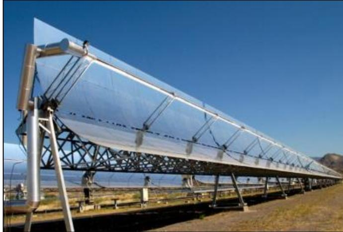
**Figura 16.** Colector cilíndrico parabólico (Clementi, 2020).
