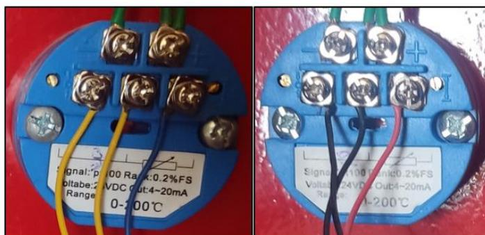
**Figura 13.** Transmisor de temperatura.
