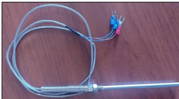
**Figura 12.** Sensor de temperatura PT 100 de tres hilos.
