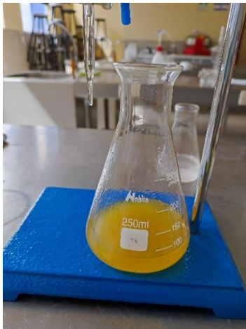
Figura 40: Determinación de peróxido de los queques
