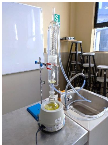
Figura 41: Determinación de grasa por el método Soxhlet
