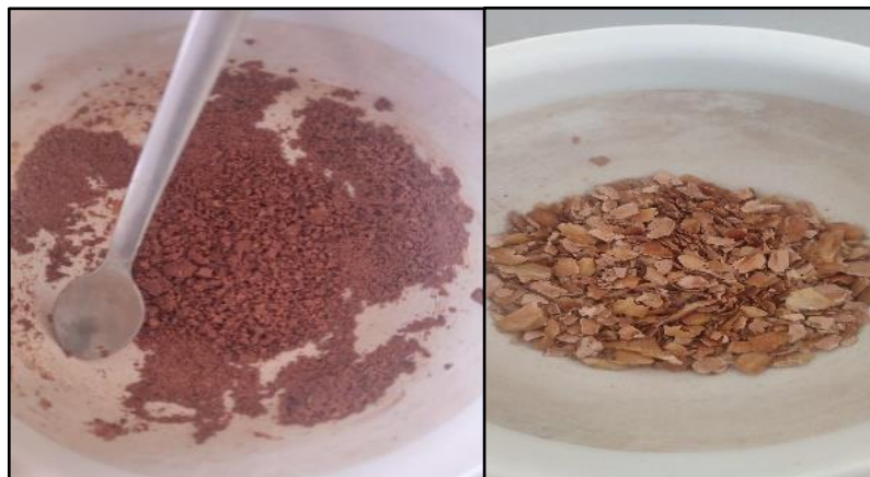
Figura 31. Preparación de muestras para los análisis de acidez, ceniza y pH (trituración)
