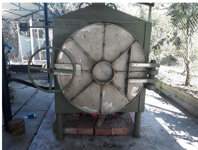
Figura 27. Horno pirolítico del ácido piroleñoso
