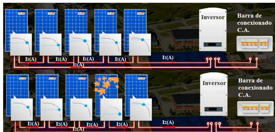
Figura 2.14: Ejemplo de operación con diferentes curvas I-V y la misma corriente en la salida de convertidores cc/cc adaptado de Teles (2017).
