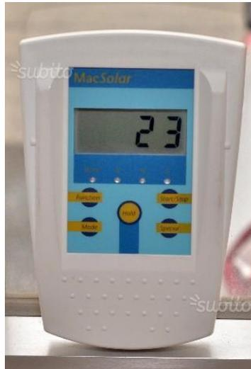
**Figura 2.8.** Piranómetro Mac Solar (SOLARC, 2019).
