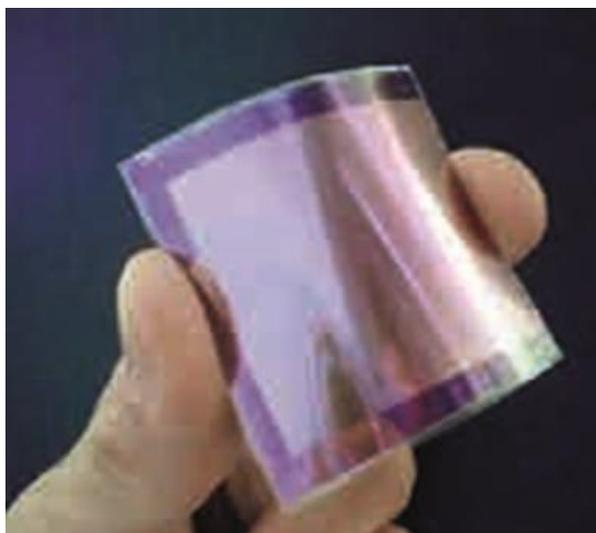
**Figura 2.4.** Célula de silicio amorfo (SA, 2018).
