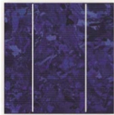
**Figura 2.6.** Célula de silicio policristalino (SA, 2018).
