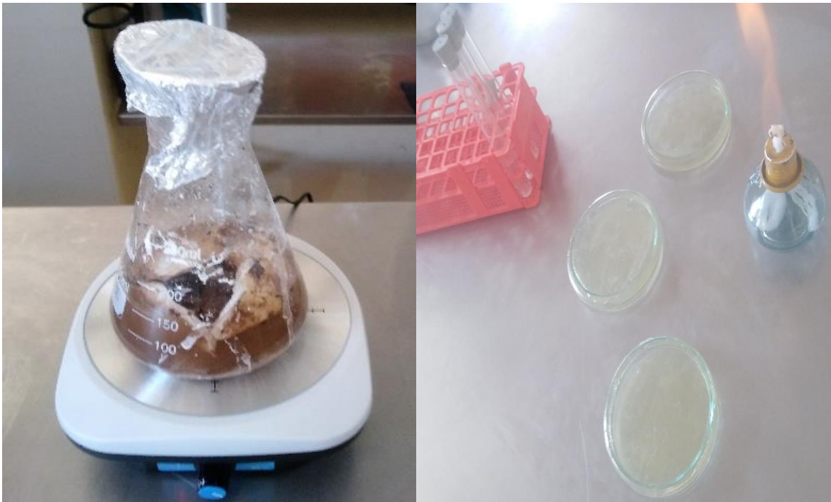
Figura 12. Suspensión de poliestireno expandido del botadero en una solución salina (NaCl) al 0.85% y primeras cepas en agar centrífide.
