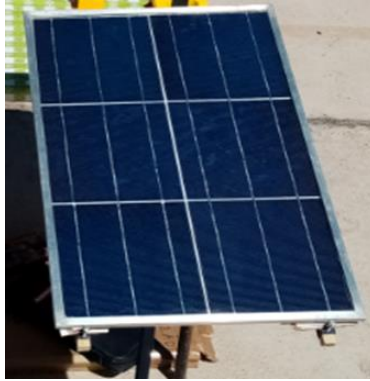
Figura 36. Modulo fotovoltaico calibrado (patrón) (Elaboración propia).
