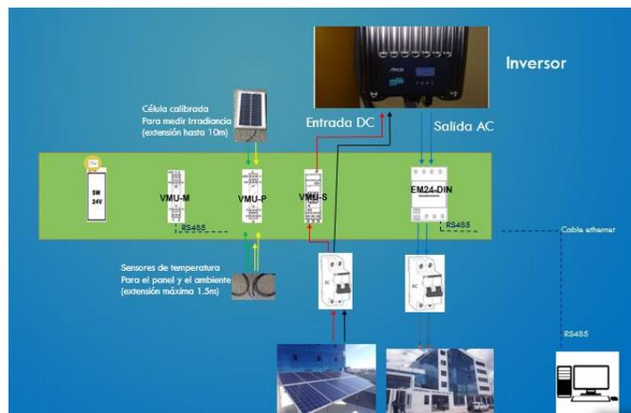
**Figura 14.** Esquema de conexiones de la instrumentación.
