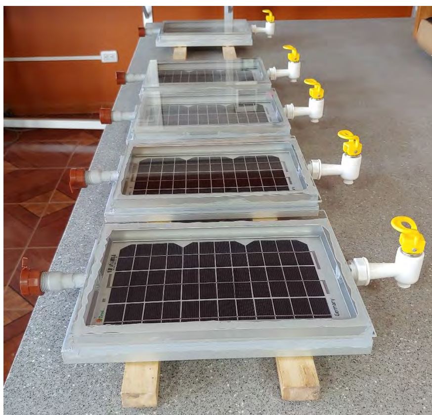
Figura 3. Acondicionamiento de los sistemas híbridos sobre listones de madera
