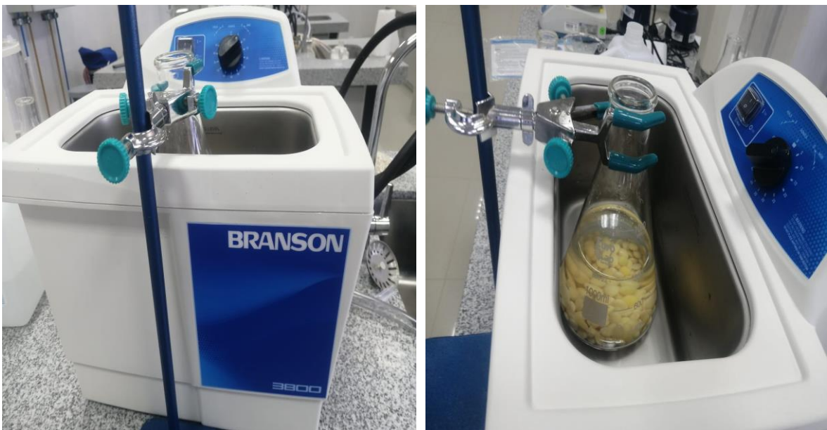
Figura 31. Desamargado del grano de tarwi por ultrasonido a 40 KHz-100 W.
