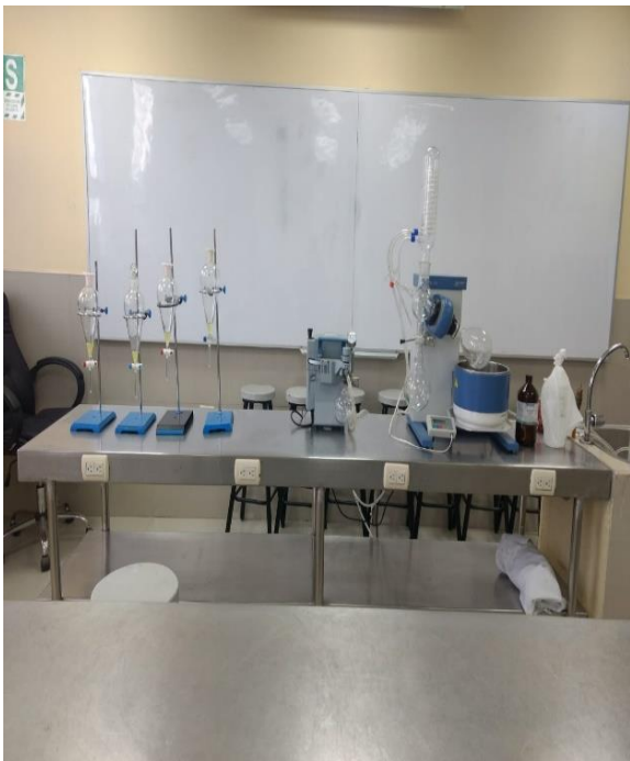
Figura 40. Extracción de alcaloides – preparación de la muestra para la extracción de los alcaloides – Elución en el rotavapor en fase líquida para el UHPLC.
