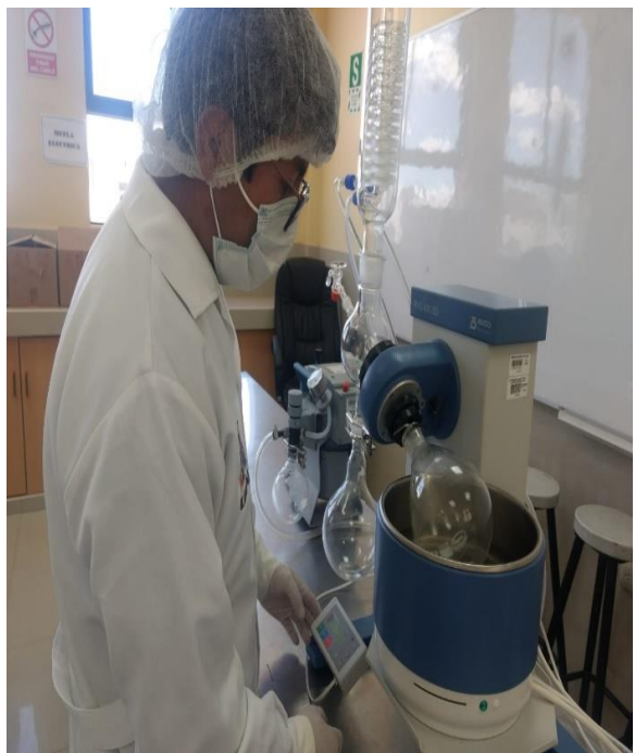
Figura 40. Extracción de alcaloides – preparación de la muestra para la extracción de los alcaloides – Elución en el rotavapor en fase líquida para el UHPLC.
