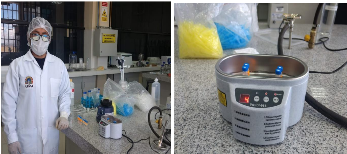
Figura 43. Extracción de las burbujas de las muestras por el sonicador antes de entrar al UHPLC.
