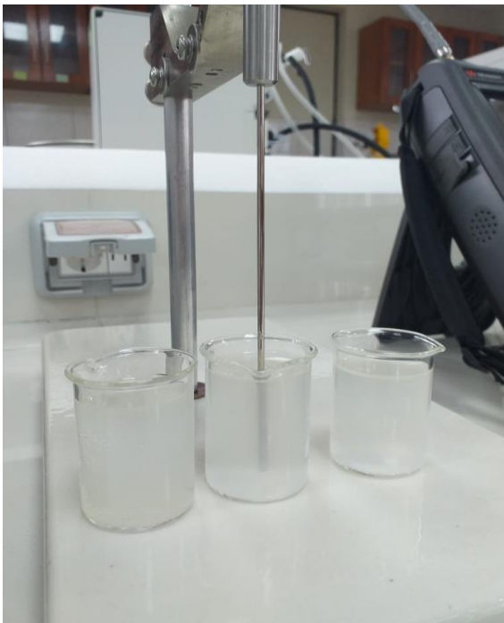
Figura 50. Secuencia de calibración del equipo dieléctrico analizador de redes vectoriales con el Standar de Lupanina de acuerdo a las concentraciones de trabajo.
