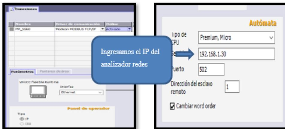
Figura 28. Configuración de conexión MODBUS TCP/IP
