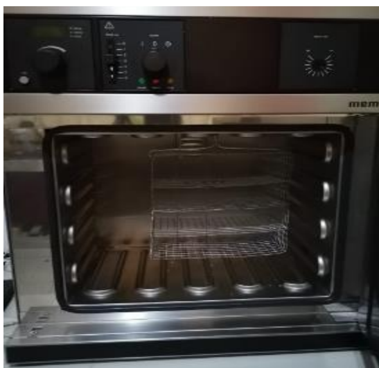
Figura 14: Esquema de secado por horno convencional (estufa)
