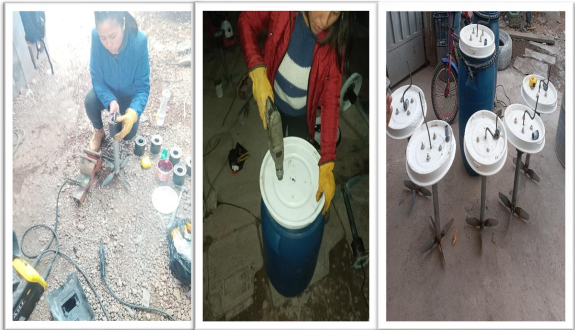
Figura 25. Construcción de las hélices para mantener la humedad homogénea dentro del biodigestor tanto para temperatura ambiente como a temperatura acondicionada con cobertura.
