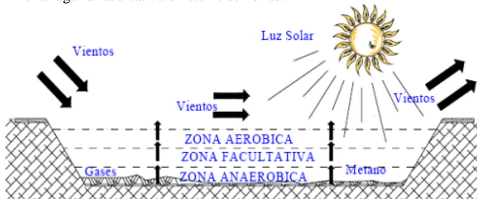
Figura 5. Zonas de una laguna facultativa: Birchall et al. (2008).
