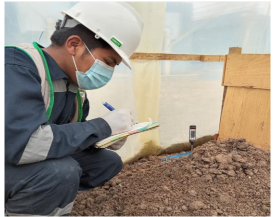
Figura 33. Monitoreo de los parámetros (temperatura, pH, humedad).
