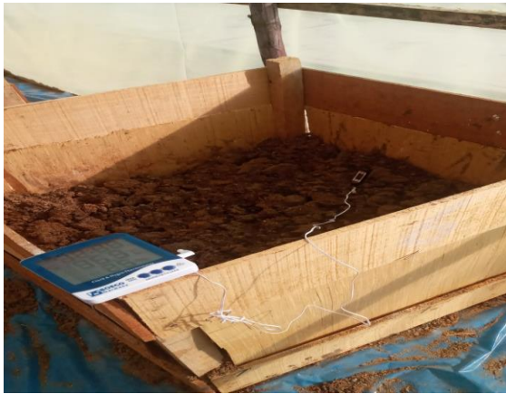
Figura 33. Monitoreo de los parámetros (temperatura, pH, humedad).
