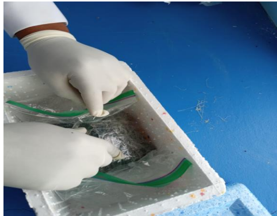
Figura 29. Toma de muestra de lecho de secado de la planta de tratamiento de aguas residuales.
