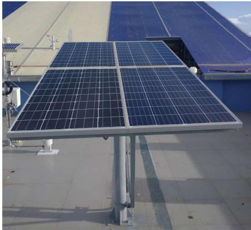
**Figura 20.** Sistemas fotovoltaicos de ambas tecnologías en la parte superior con limpieza y en la inferior expuestos al polvo – estación lluviosa, 22 de marzo del 2022.
