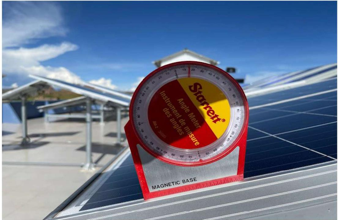
**Figura 23.** Inclinación de los sistemas fotovoltaicos a  $15^\circ$  con orientación norte.
