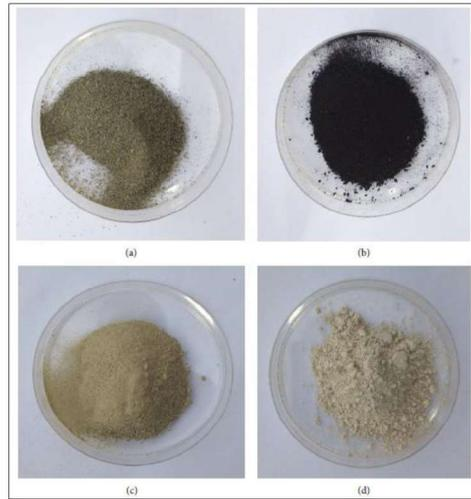
**Figura 3.** Muestras de polvo: (a) polvo de agregados; (b) polvo de carbón; (c) polvo de la industria de fertilizantes; (d) yeso polvo de la industria (Andrea, Pogrebnaya & Kichonge, 2019).
