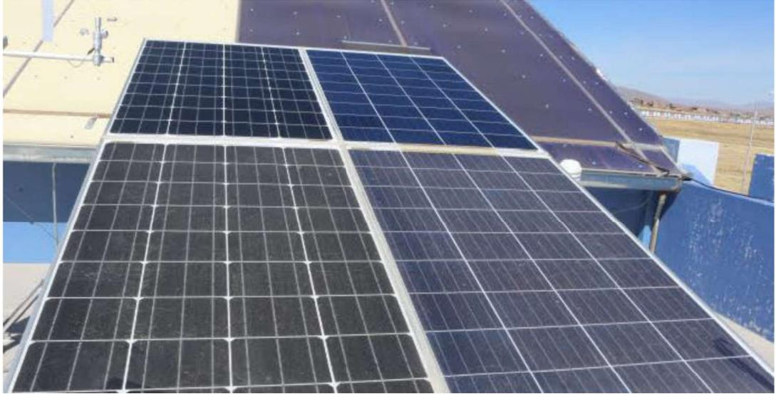
**Figura 21.** Sistemas fotovoltaicos de ambas tecnologías en la parte superior con limpieza y en la inferior expuestos al polvo – estación seca, 18 de mayo del 2022.
