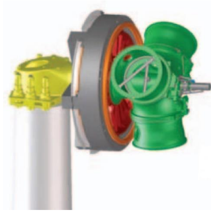
Figura 42. Accionamiento directo Enercon.
