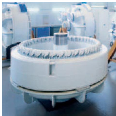
Figura 43. Generador Multipolo en anilla – Enercon (Enercon, 2022).
