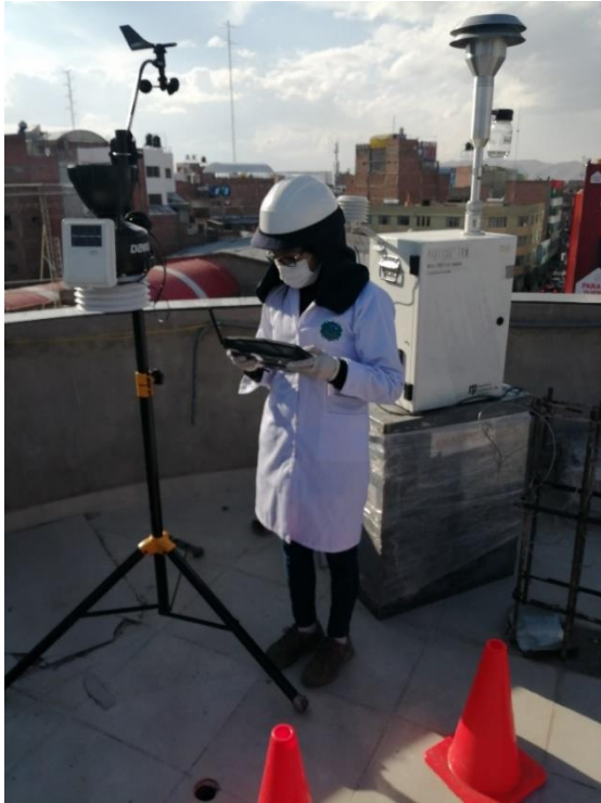
Figura 28. Configuración de la estación meteorológica Davis Pro.
