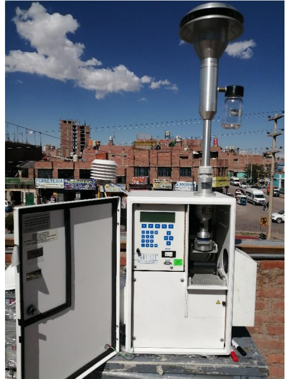
Figura 37. Equipo de monitoreo de PM 2.5 PARTISOL.
