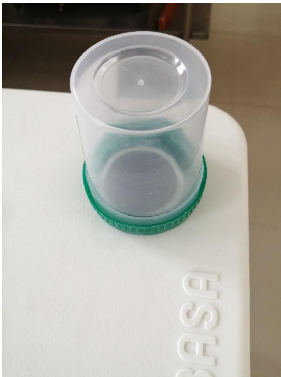
Figura 46. Filtro de cuarzo con muestra de PM 2.5 dentro de un frasco esterilizado.
