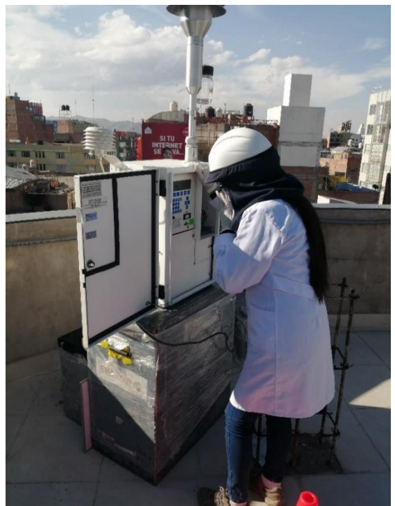
Figura 27. Configuración de muestreador PM 2.5 PARTISOL.
