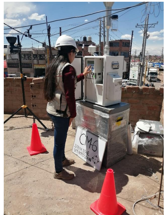
Figura 43. Configuración de muestreador PM 2.5 PARTISOL.
