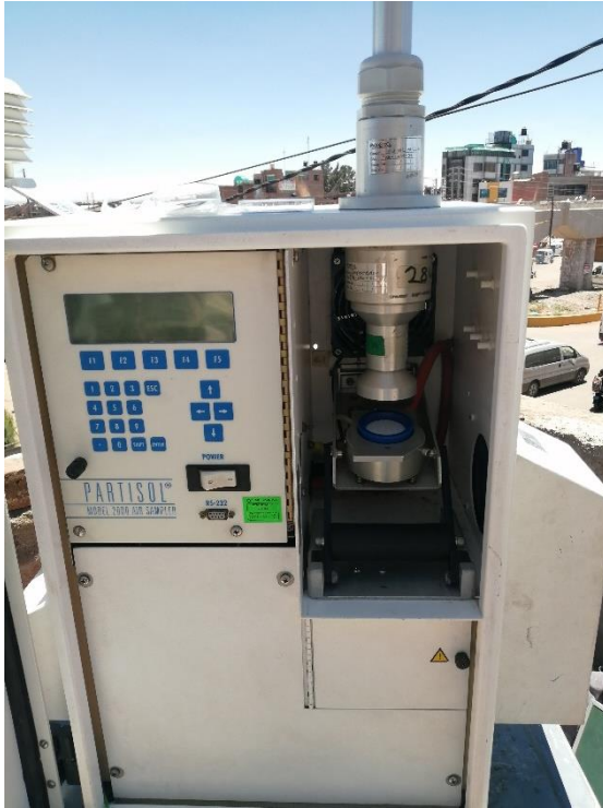
Figura 40. Colocación del portafiltro al muestreador PARTISOL EM-3.
