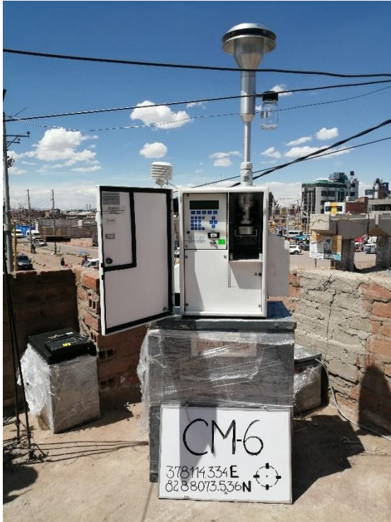
Figura 44. Equipo de monitoreo de PM 2.5 PARTISOL EM-3.
