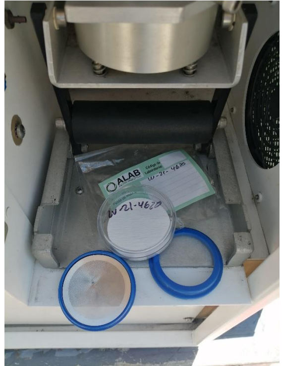
Figura 41. Salida del portafiltro del PARTISOL.
