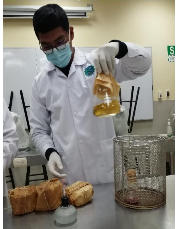
Figura 57. Medios de cultivo después de haber sido retirados de la autoclave.
