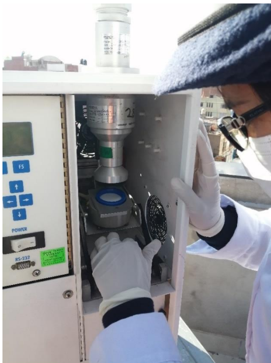
Figura 26. Colocación del portafiltro al muestreador PARTISOL.
