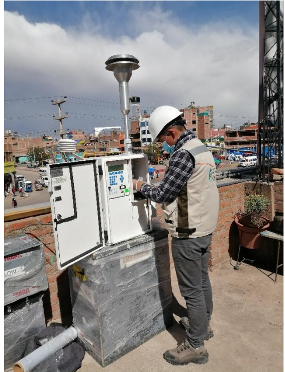
Figura 33. Colocación del portafiltro al muestreador PARTISOL.
