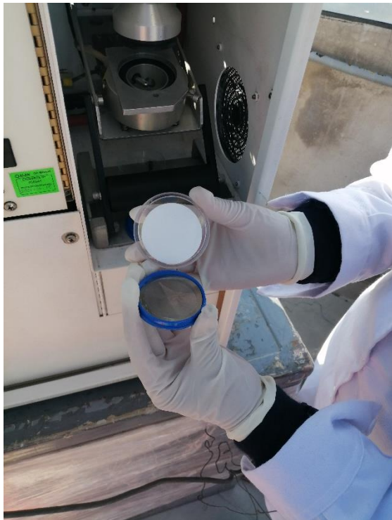
Figura 24. Verificación de las buenas condiciones del filtro de teflón.
