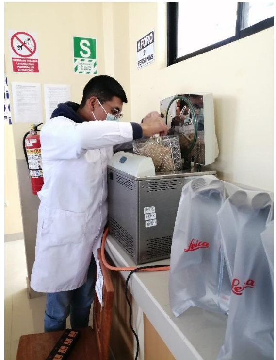
Figura 51. Introducción de placas petri a la autoclave.
