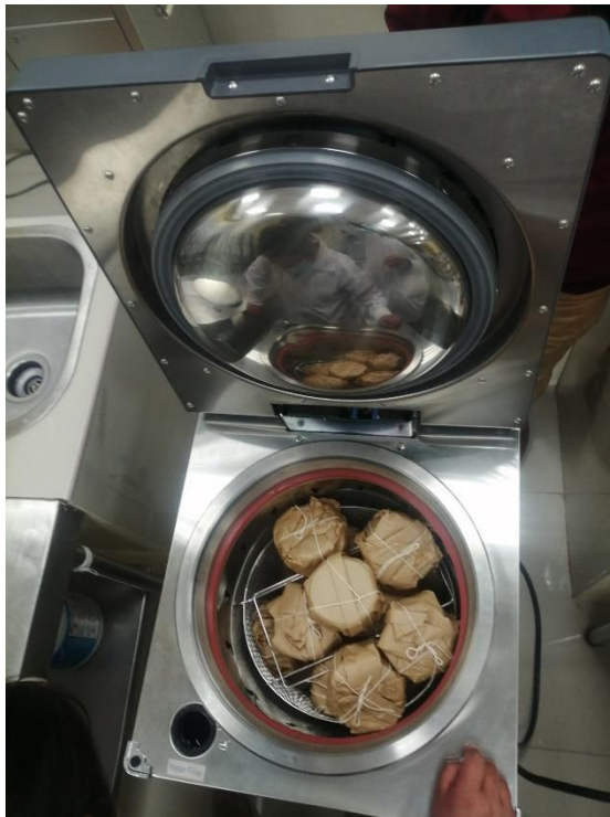
Figura 68. Medios de cultivo dentro de una autoclave de 50 L.
