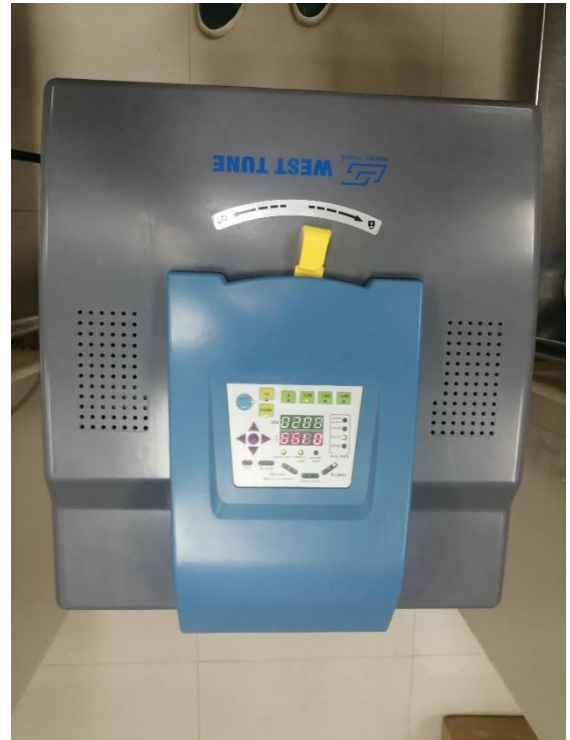
Figura 73. Programación de autoclave, esterilización a 121°C.
