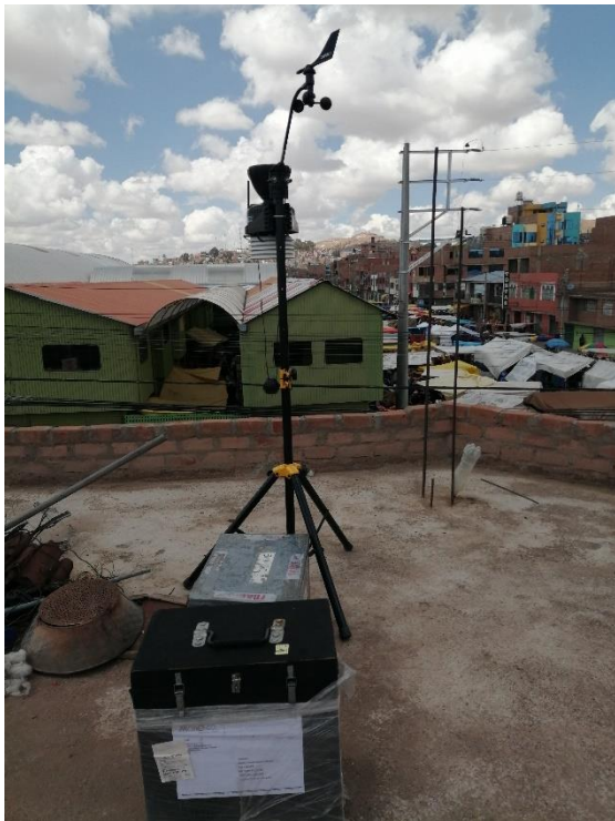
Figura 20. Prueba de monitoreo – Estación meteorológica.
