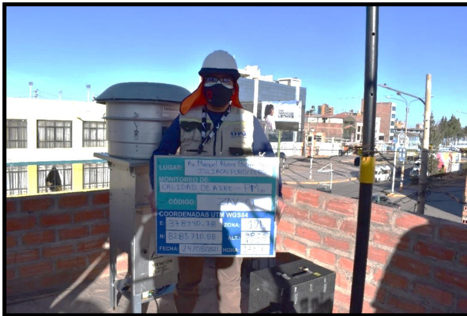
Imagen N° 01.- Monitoreo de material particulado menor a 10 micras y condiciones meteorológicas en la zona de alto tránsito vehicular – ZAV – 1, en dirección Av. Manuel Núñez Butrón N° 522 – Juliaca (Salida Puno), de fecha 24/08/2021.
