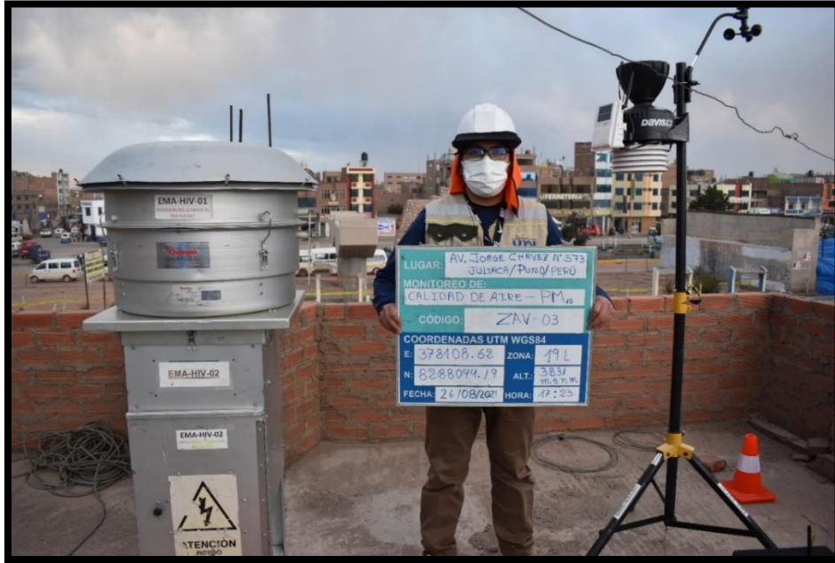
Imagen N° 03.- Monitoreo de material particulado menor a 10 micras y condiciones meteorológicas en la zona de alto tránsito vehicular – ZAV – 3, en dirección Av. Jorge Chávez N° 573– Juliaca (Salida Cusco), de fecha 26/08/2021.
