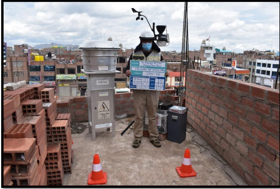
Imagen N° 11.- Monitoreo de material particulado menor a 10 micras y condiciones meteorológicas en la zona de alto tránsito vehicular – ZAV – 2, en dirección Av. Huancané N° 144 – Juliaca (Salida Huancané), de fecha 21/12/2021.
