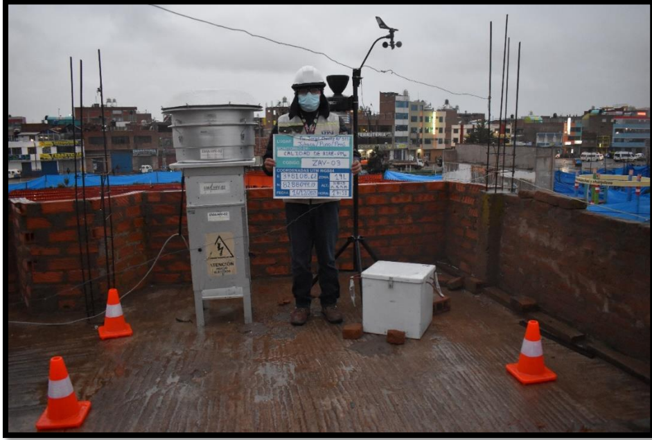
Imagen N° 09.- Monitoreo de material particulado menor a 10 micras y condiciones meteorológicas en la zona de alto tránsito vehicular – ZAV – 3, en dirección Av. Jorge Chávez N° 573– Juliaca (Salida Cusco), de fecha 16/12/2021.
