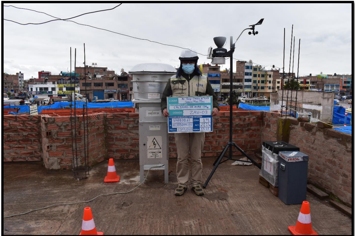
Imagen N° 12.- Monitoreo de material particulado menor a 10 micras y condiciones meteorológicas en la zona de alto tránsito vehicular – ZAV – 3, en dirección Av. Jorge Chávez N° 573– Juliaca (Salida Cusco), de fecha 22/12/2021.
