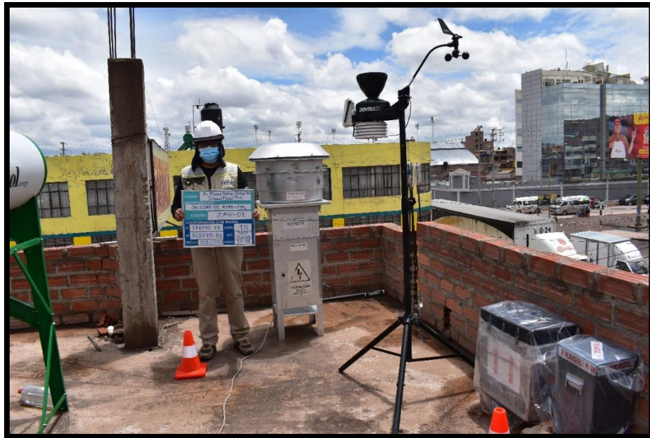
Imagen N° 10.- Monitoreo de material particulado menor a 10 micras y condiciones meteorológicas en la zona de alto tránsito vehicular – ZAV – 1, en dirección Av. Manuel Núñez Butrón N° 522 (Salida Puno), de fecha 20/12/2021.
