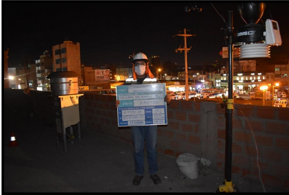
Imagen N° 05.- Monitoreo de material particulado menor a 10 micras y condiciones meteorológicas en la zona de alto tránsito vehicular – ZAV – 2, en dirección Av. Huancané N° 123– Juliaca (Salida Huancané), de fecha 31/08/2021.
