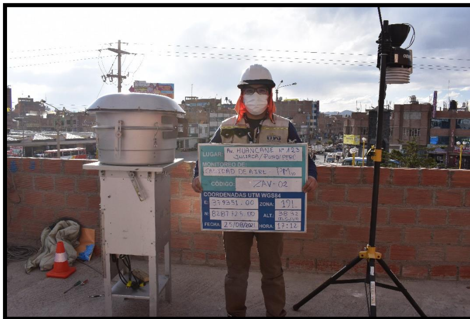
Imagen N° 02.- Monitoreo de material particulado menor a 10 micras y condiciones meteorológicas en la zona de alto tránsito vehicular – ZAV – 2, en dirección Av. Huancané N° 123– Juliaca (Salida Huancané), de fecha 25/08/2021.
