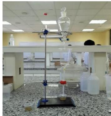
**Figura 34: Dispositivo para medir fuerza gel**
