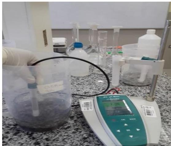
**Figura 25: Medición del pH de las muestras**
