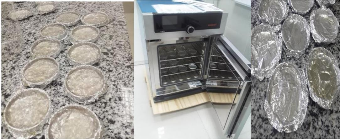
**Figura 28:** Secado del colágeno a 75°C por 12 horas
