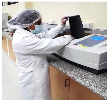
**Figura 42:** Medición de la absorbancia en espectrofotómetro
