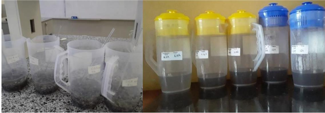
**Figura 23: Hidrólisis a diferentes tiempos y concentraciones de NaOH**
