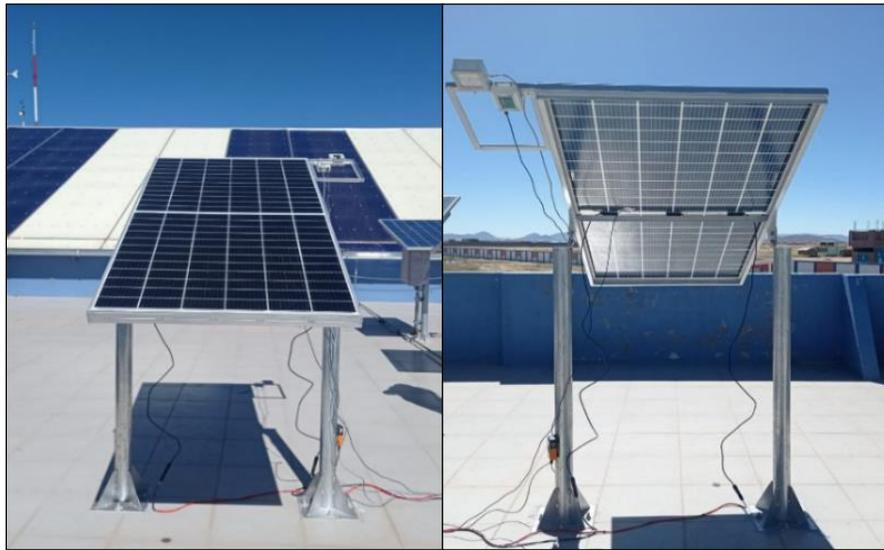
**Figura 28.** Trazado de curvas I-V del módulo fotovoltaico bifacial.
