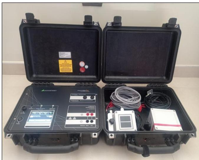
**Figura 15.** Trazador de curvas I-V Gossen Metrawatt Profitest PV del laboratorio de energía fotovoltaica de la EPIER.
