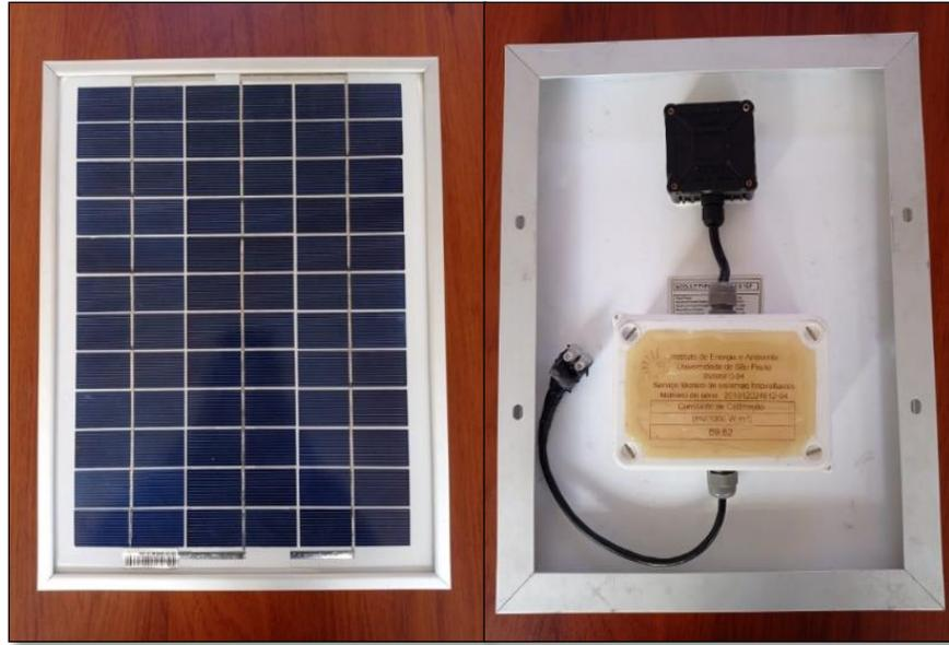
**Figura 19.** Celda calibrada para medir irradiancia.
