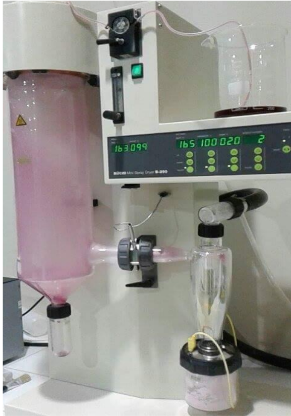
Figura V. Sistema de atomización empleado en el microencapsulamiento de betalaínas de quinua en maltodextrina
