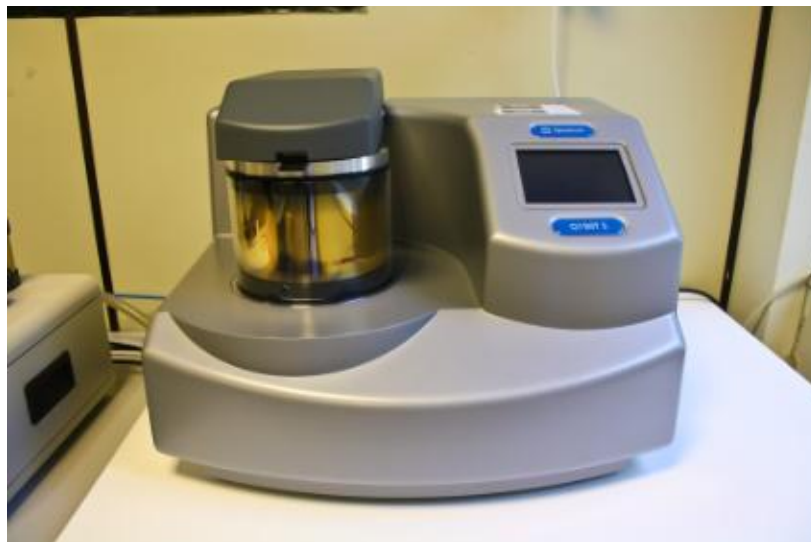
Figura X. Sistema de recubrimiento con metales Q150T-S para el análisis por microscopía de barrido electrónico
