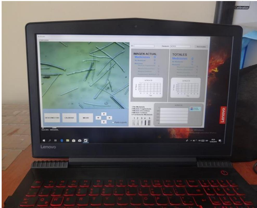
Figura 43. Lectura e identificación de los tipos de medulación en la fibra con el equipo Medulómetro de fibras
