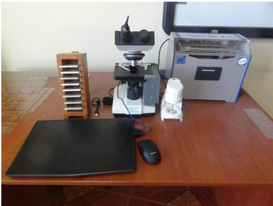
*Figura 38.* Equipo Fiber EC y Medulómetro de fibras; para la medición de las variables de la fibra de alpaca
