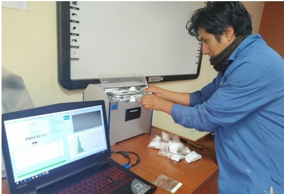
*Figura 41.* Análisis de cada muestra con el equipo Fiber EC. para determinar el diámetro y el factor de confort
