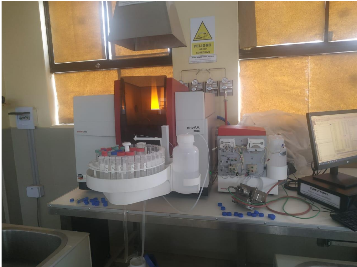
Figura 22. Determinación de metales pesados por espectroscopía de absorción atómica mediante flama
