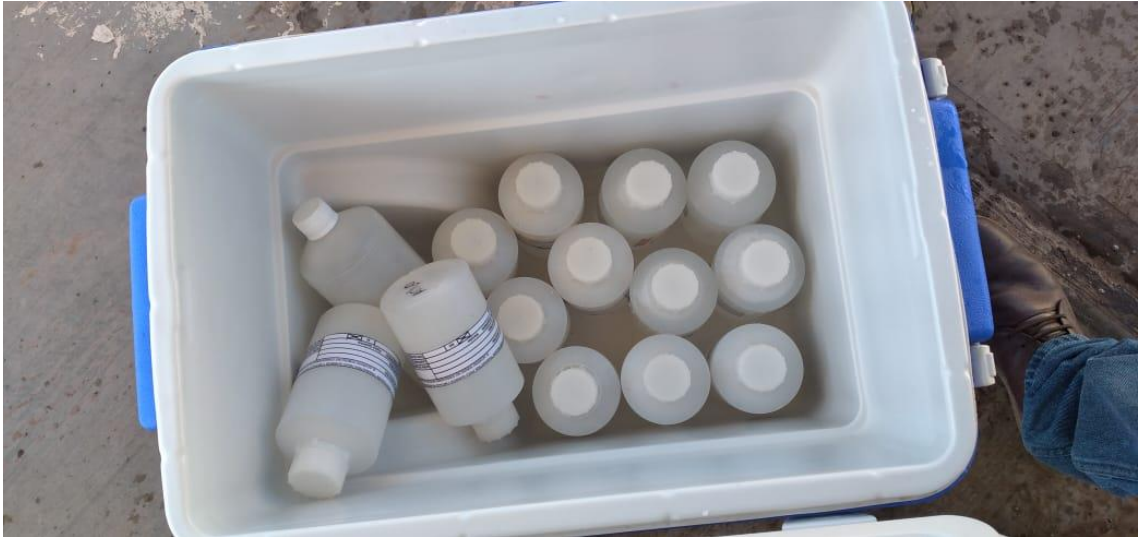
Figura 20. Almacenamiento y preservación de muestras para traslado a laboratorio.
