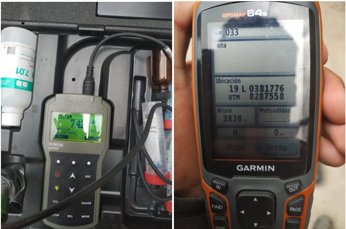
Figura 19. Determinación de pH y georreferenciación de puntos de monitoreo.
