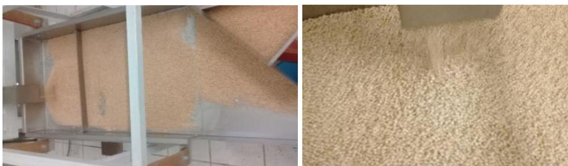
*Figura 38:* Pulido de quinua expandida con una adaptación de una escarificadora.
