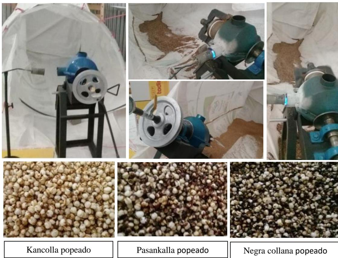
*Figura 37:* Cañón expansor por explosión capacidad 1 kg por Bach. De prueba con tapa teflón e interior material acero inox. – Instalaciones de la Cooperativa Agroindustrial Cabana Ltda.
