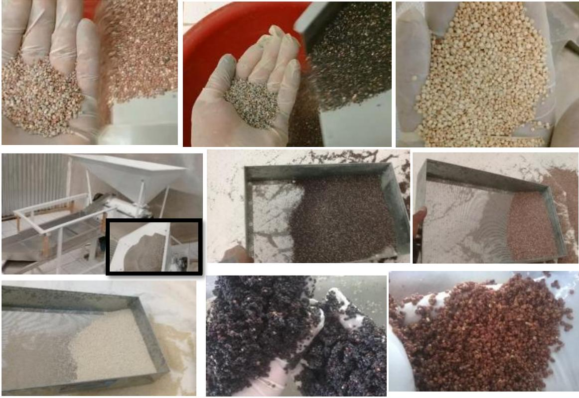
Figura 35: Proceso de escarificado y obtención de quinua perlada – COOPAIN CABANA.
