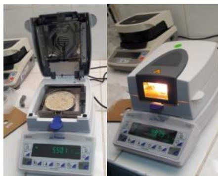
*Figura 24:* Analizador de humedad o termobalanza
