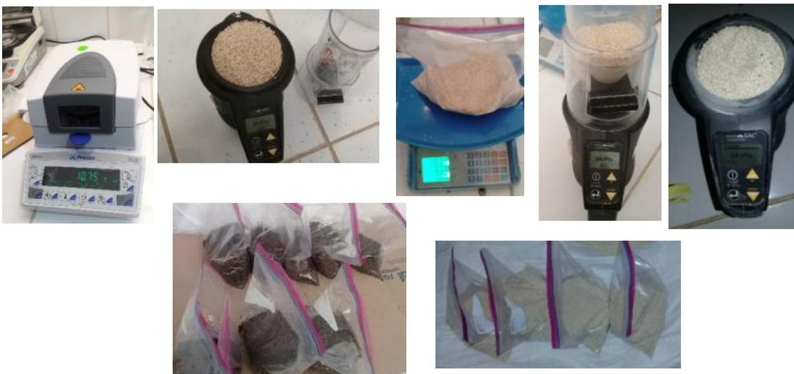
Figura 36: Acondicionamiento y determinación de humedad
