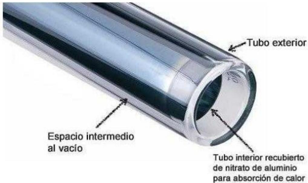
**Figura 3.8:**Tubo de vacío (Thermosol)
