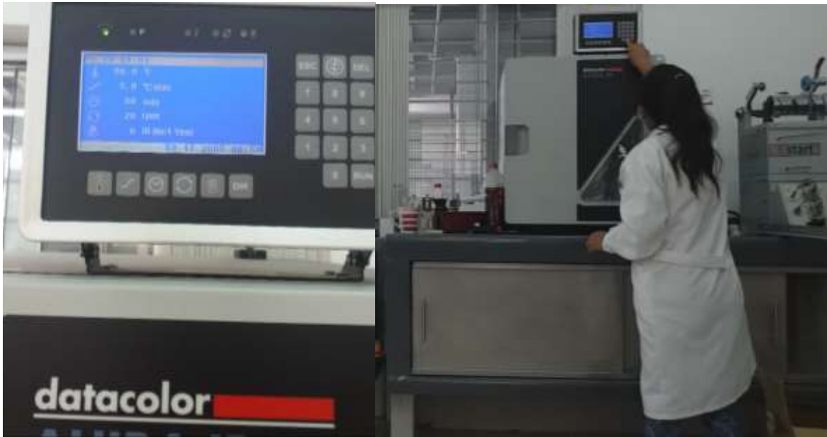
Figura 13. Programación de los parámetros de teñido (temperatura y tiempo) en el equipo
