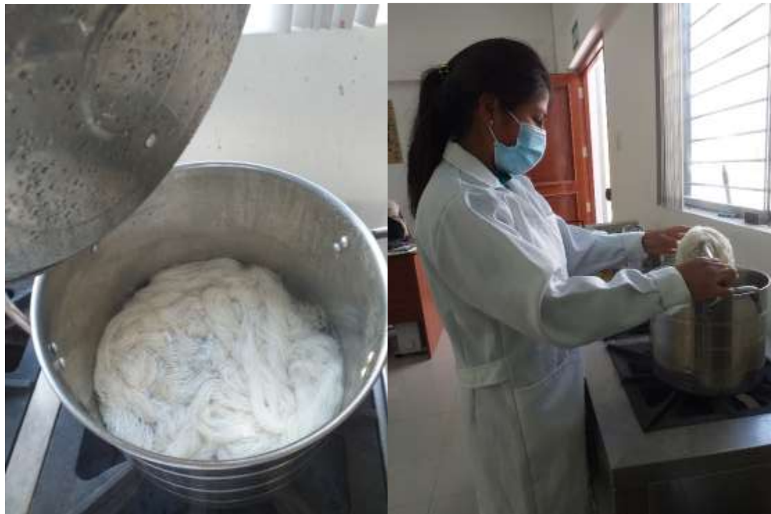
Figura 8. Premordentado del hilo de alpaca con crémor tártaro y sulfato de aluminio
