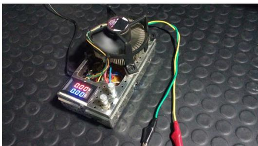
**Figura 3.6. Carga electrónica (Adaptación propia).**
