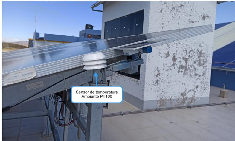
**Figura 3.59. Sensor de temperatura ambiente (Elaboración propia).**
