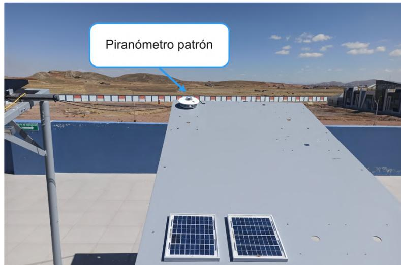
**Figura 3.50. Piranómetro patrón instalado en la terraza del Instituto de Investigación en Energías Renovables y Eficiencia Energética de la Universidad Nacional de Juliaca – Sede Ayabacas (Elaboración propia).**
