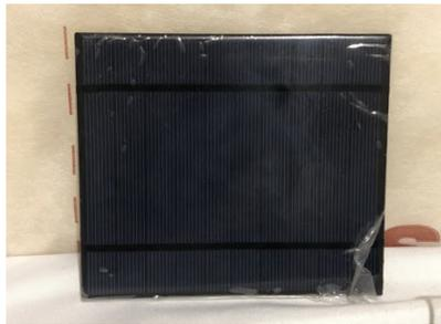
**Figura 3.17. Célula solar 5 Voltios 2,5 Watts (Elaboración propia).**
