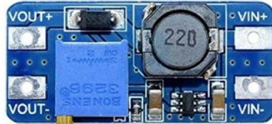
**Figura 3.10. Modulo convertidor elevador MT3608 (fitipower, 2021).**
