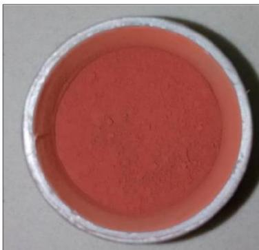
**FIGURA N°1.** Muestra de Hidralginita pretratada con óxidos de hierro M-02.
