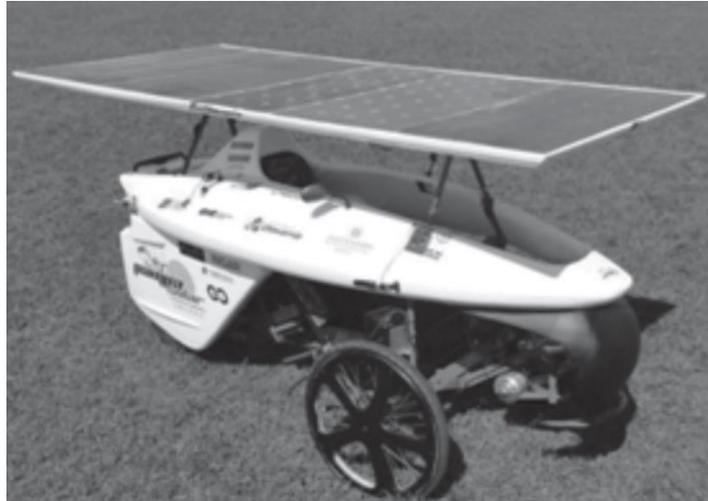
**Figura 2.3:** Versión final del vehículo, con paneles y carenado adaptado de Rossi et al (2014).
