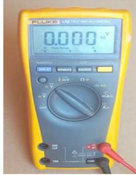
**Figura 3.5:** Multímetro digital FLUKE 179 adaptacion propia
