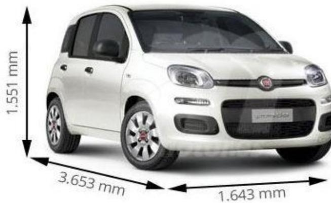
*Figura 2.4:* Longitud, ancho y altura de un vehículo adaptado de Lizano (2017).
