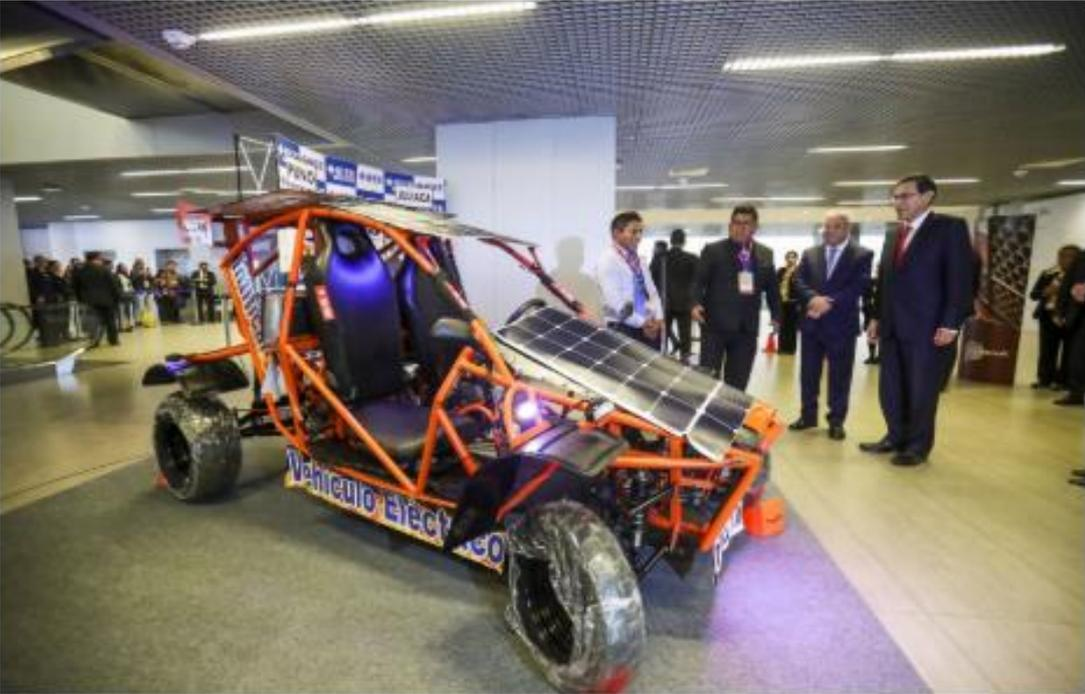
Es un vehículo impulsado con energía solar fotovoltaica, con una estructura metálica y paneles solares flexibles.
