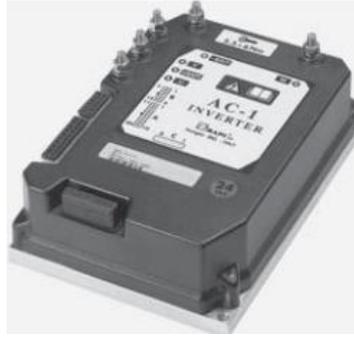
*Figura 3.3:* Controlador de velocidad adaptado de Carreño Aguillon et al (2012).
