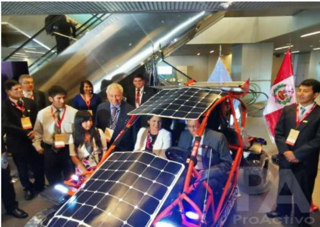
*Es un vehículo impulsado con energía solar fotovoltaica, con una estructura metálica y paneles solares flexibles.*
