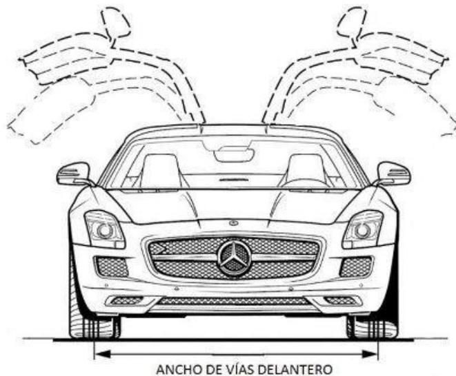
**Figura 2.7:** Ancho de vías delantero adaptado de Lizano (2017)
