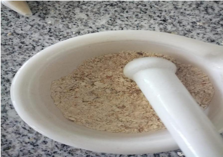
**Figura 20: Triturado de la muestra seca.**
