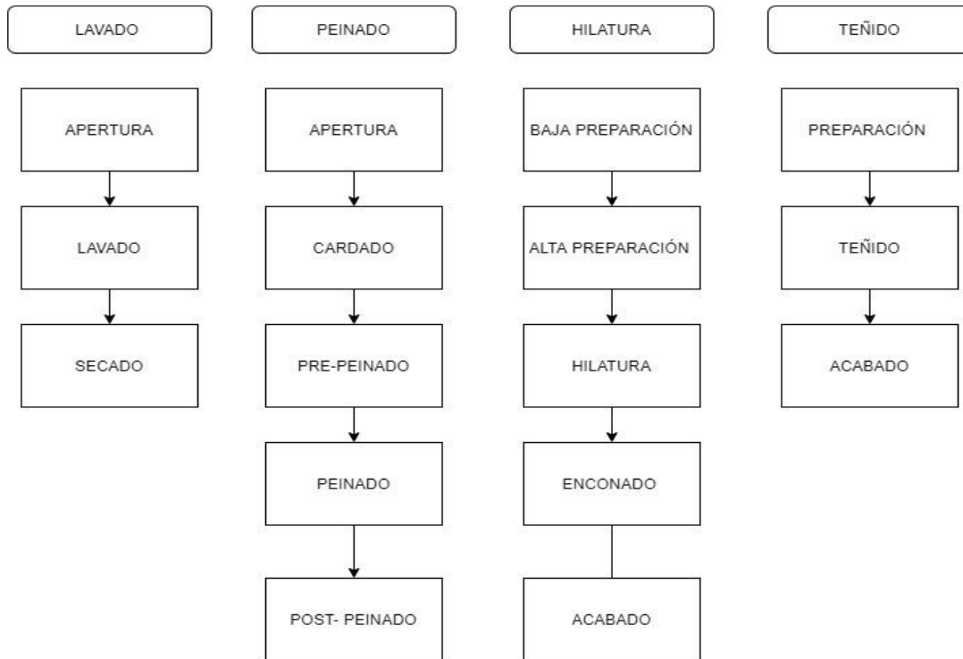
Figura 3. Proceso de transformación de fibra a hilados teñidos.
