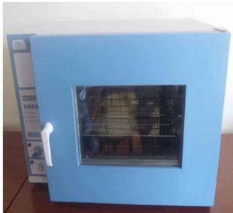
Figura 26. Estufa para el secado de las muestras.
