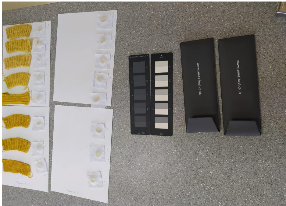
Figura 79. Evaluación de la solidez de color al frote con la escala de grises a la transferencia de color.
