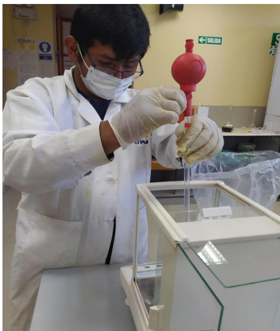
Figura 72. Pipeteado de los auxiliares textiles
