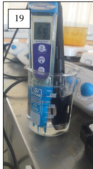
Figura 32. (18) monitoreo de oxígeno disuelto, (19) monitoreo de pH, potencial redox.
