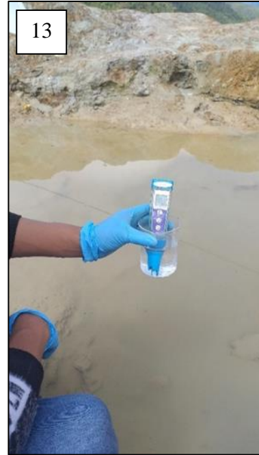
Figura 29. (12) muestreo de efluente minero, (13) medición de parámetros fisicoquímicos.
