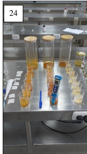
Figura 35. (23) lechada de cal al 5% en suspensión constante, (24) fase de neutralización química con lechada de cal al 5%(m/v).
