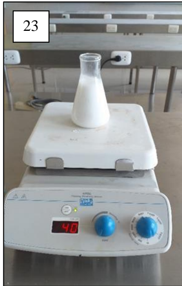
Figura 35. (23) lechada de cal al 5% en suspensión constante, (24) fase de neutralización química con lechada de cal al 5%(m/v).
