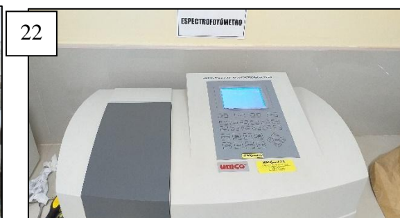
Figura 34. (21) determinación de \text{Fe}^{+2} , (22) espectrofotómetro UV/VIS para la determinación de \text{Fe}^{+2} y Hierro total.
