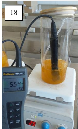
Figura 32. (18) monitoreo de oxígeno disuelto, (19) monitoreo de pH, potencial redox.
