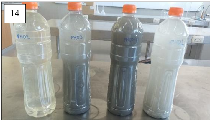
Figura 30. (14) muestras de efluentes mineros, (15) submuestras para envío de análisis químico de metales.
