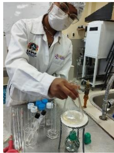
Evaluacion de indice de acidez en la etapa de almacenamiento de aceite de soya en el laboratorio de Ingeniería en Industrias Alimentarias –UNAJ
