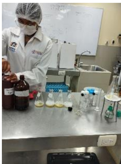
Evaluacion de indice de peroxidos en la etapa de almacenamiento de aceite de soya en el laboratorio de Ingeniería en Industrias Alimentarias –UNAJ
