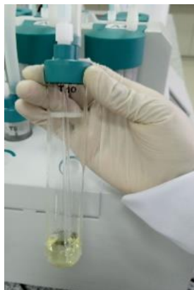
Aceite de la muestra testigo 15h OSI
