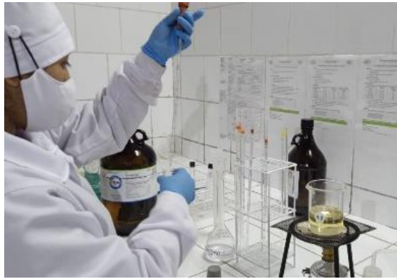
Evaluacion de indice de acidez y peroxidos en la etapa de envasado de aceite de soya en el departamento de calidad de la empresa RIO GRANDE DISTRIBUCIONES S.A.C.
