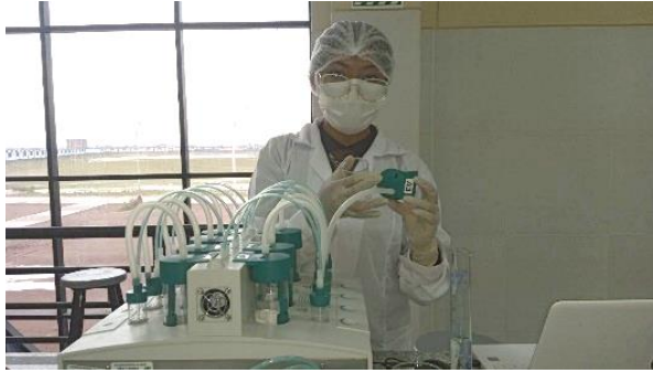
Adicion de 60ml de agua destilada en cada vaso por celda
