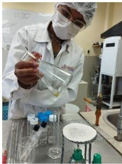
Evaluacion de indice de acidez en la etapa de almacenamiento de aceite de soya en el laboratorio de Ingeniería en Industrias Alimentarias –UNAJ
