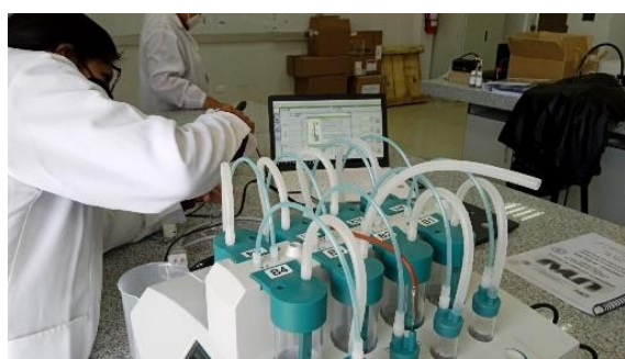
Conexión y encendido del equipo Rancimat
