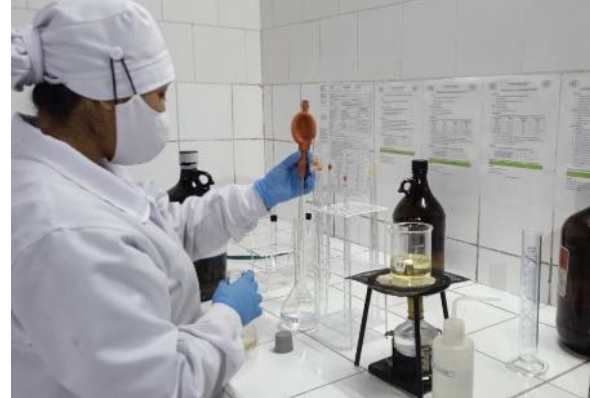
Evaluacion de indice de acidez y peroxidos en la etapa de envasado de aceite de soya en el departamento de calidad de la empresa RIO GRANDE DISTRIBUCIONES S.A.C.
