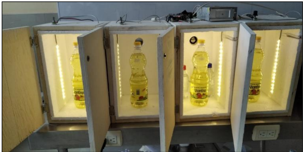
Cajas de control en ejecucion y regulacion de iluminacion y temperatura
