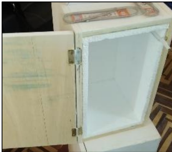
Armado de caja hermética de control de iluminación y temperatura
