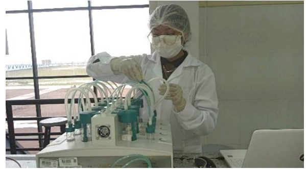
Conexión adecuada de los tubos del flujo de gas y de la conductividad del agua
