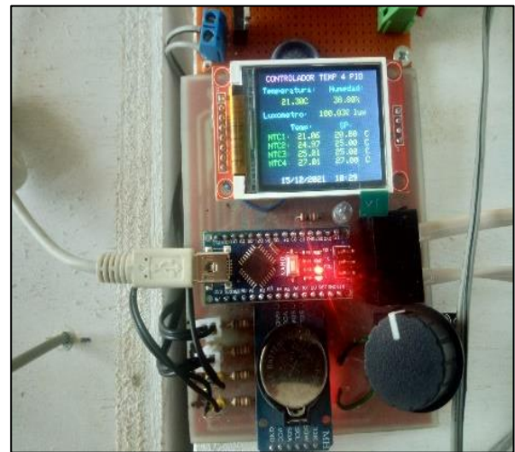
Pantalla control, incluye sensores de temperatura y luz
