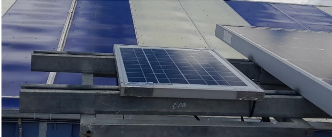
Figura 16. Celda fotovoltaica calibrada para medir la radiación solar incidente en el SFCR.
