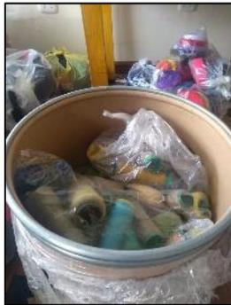
Los conos de hilos están almacenados en cilindros y no se puede apreciar con claridad la cantidad, el color, tipo y código de los hilos (Falta de estantes).
