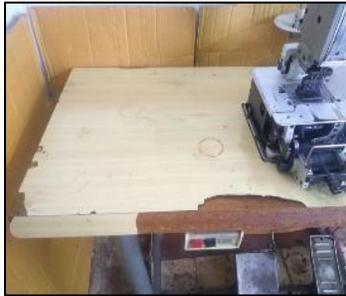
No limpian el mueble de la máquina eso genera desgaste de la misma, y daño en las prendas (Falta de limpieza).
