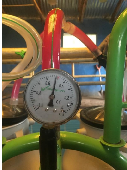
Figura 19. Vacuometro para presión de vacío de la máquina de ordeño.
