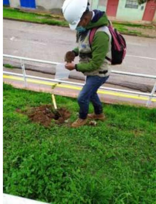
*Figura 34.* Recolección muestras del suelo por el método del cilindro
