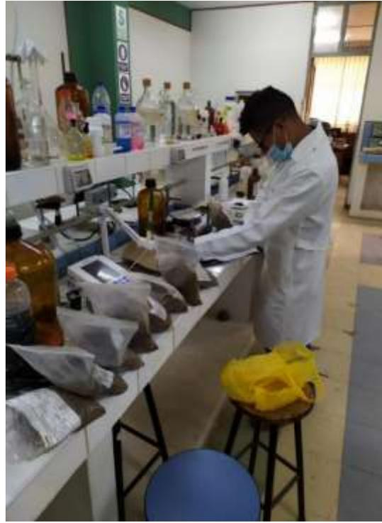
*Figura 38.* Pesado de muestras de suelo en la balanza analítica
