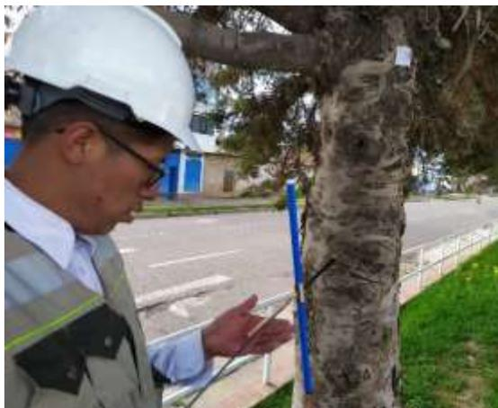
*Figura 50.* Extracción de muestras de madera verde
