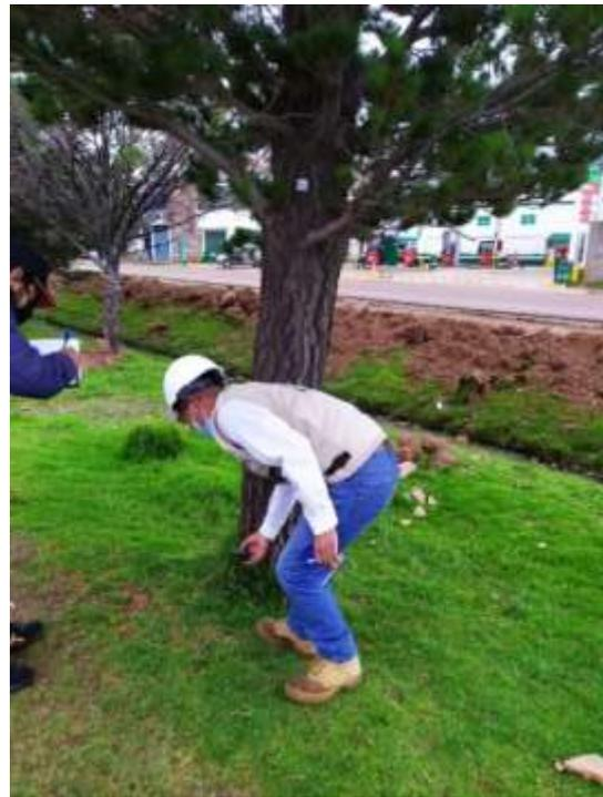
*Figura 24. Recolección de puntos con el GPS GARMIN-64 SC*
