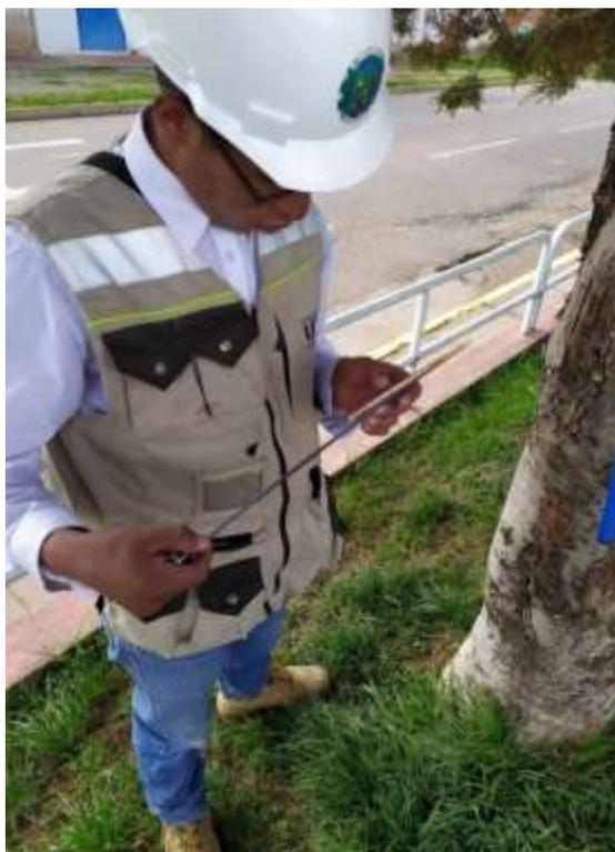
*Figura 52.* Muestras de madera extraído con el extractor de barreno de Pressler
