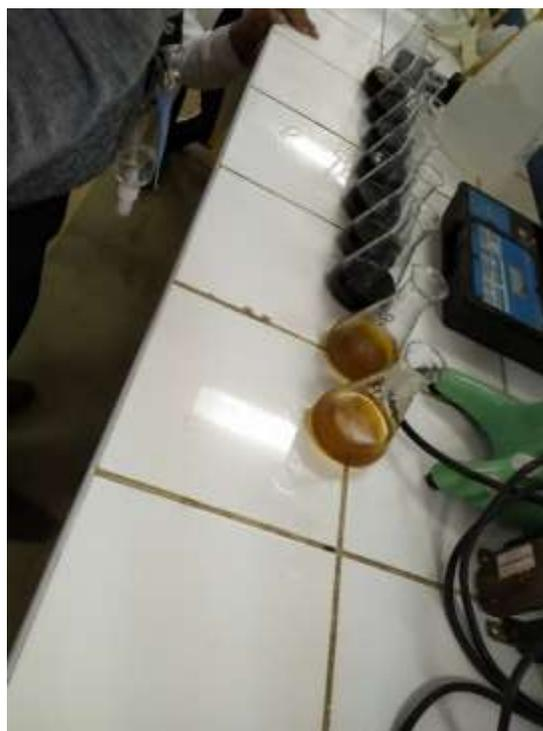
*Figura 48.* Valoración de las muestras del suelo para el cálculo del porcentaje de materia orgánica
