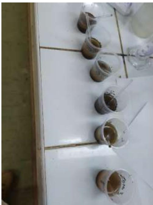
*Figura 45.* Muestras de suelo para la determinación del pH y conductividad eléctrica
