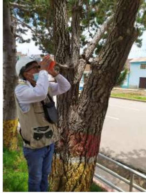
*Figura 30.* Medición de la altura total del árbol
