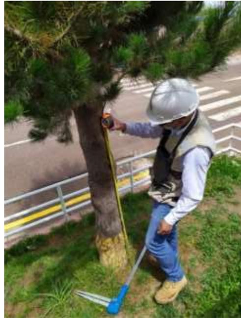
*Figura 26.* Medida de altura para el DN (1.30m)
