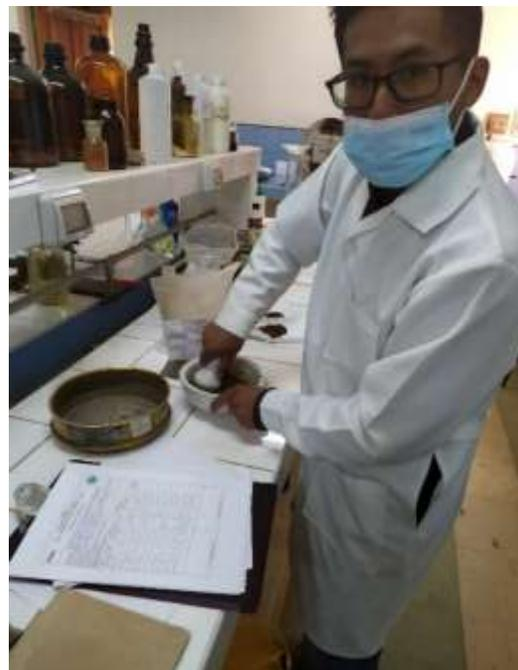
*Figura 42.* Molido del suelo seco y tamizado en la malla de 5mm
