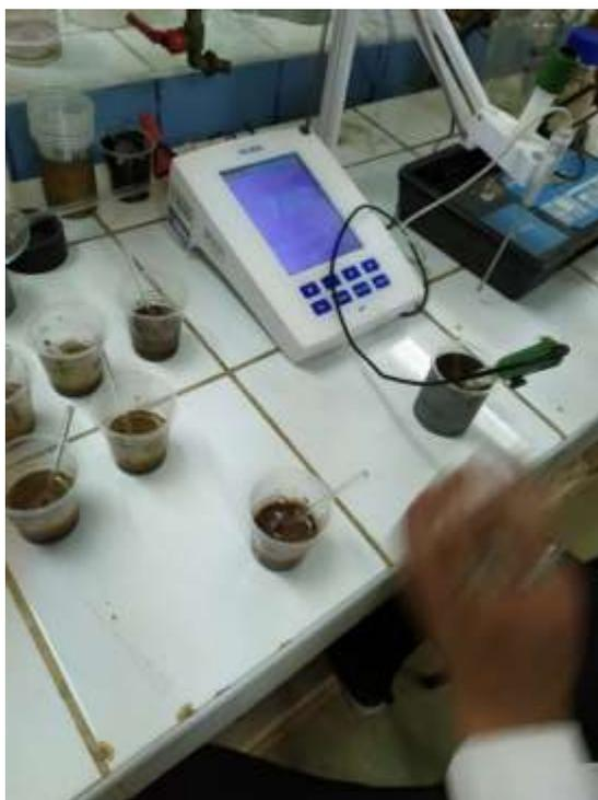
*Figura 47.* Determinación de la conductividad eléctrica de las muestras del suelo
