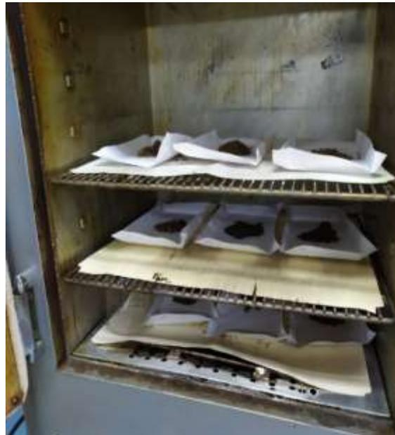
*Figura 40.* Secado de muestras de suelo en la estufa
