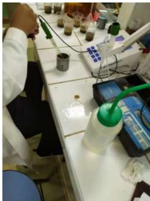
*Figura 46.* Determinación del pH con el pHmetro
