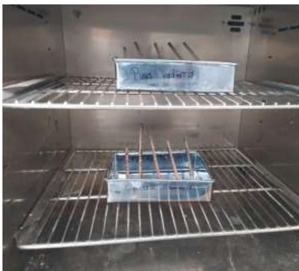
Figura 55. Muestras de madera de *Pinus radiata* y *Cupressus macrocarpa* en la estufa
