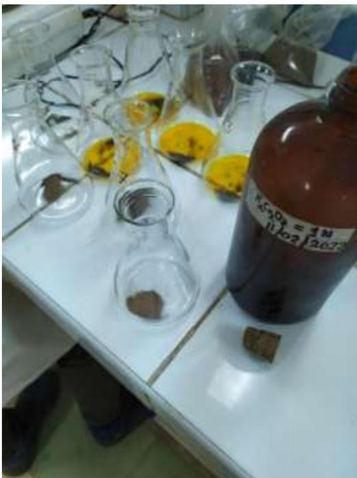
*Figura 43.* Muestras de suelo en matraces con dicromato de potasio
