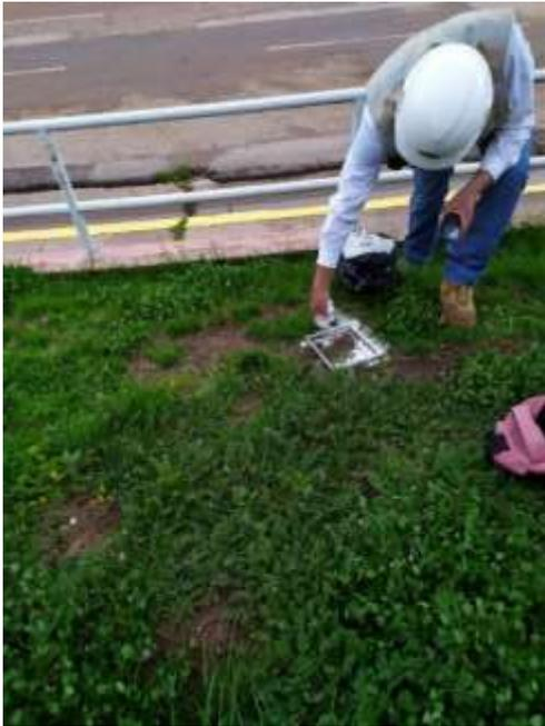
*Figura 25.* Marcado de puntos para la recolección de muestras del suelo
