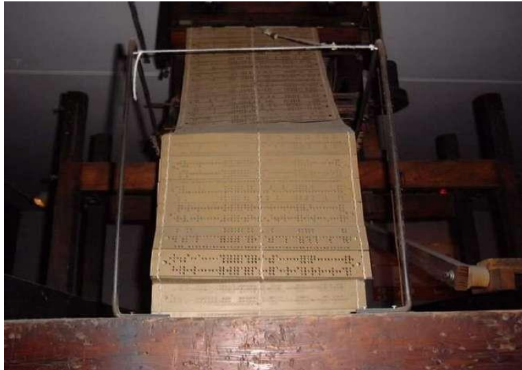
Figura 3: Telares Jacquard con tarjetas perforadas
