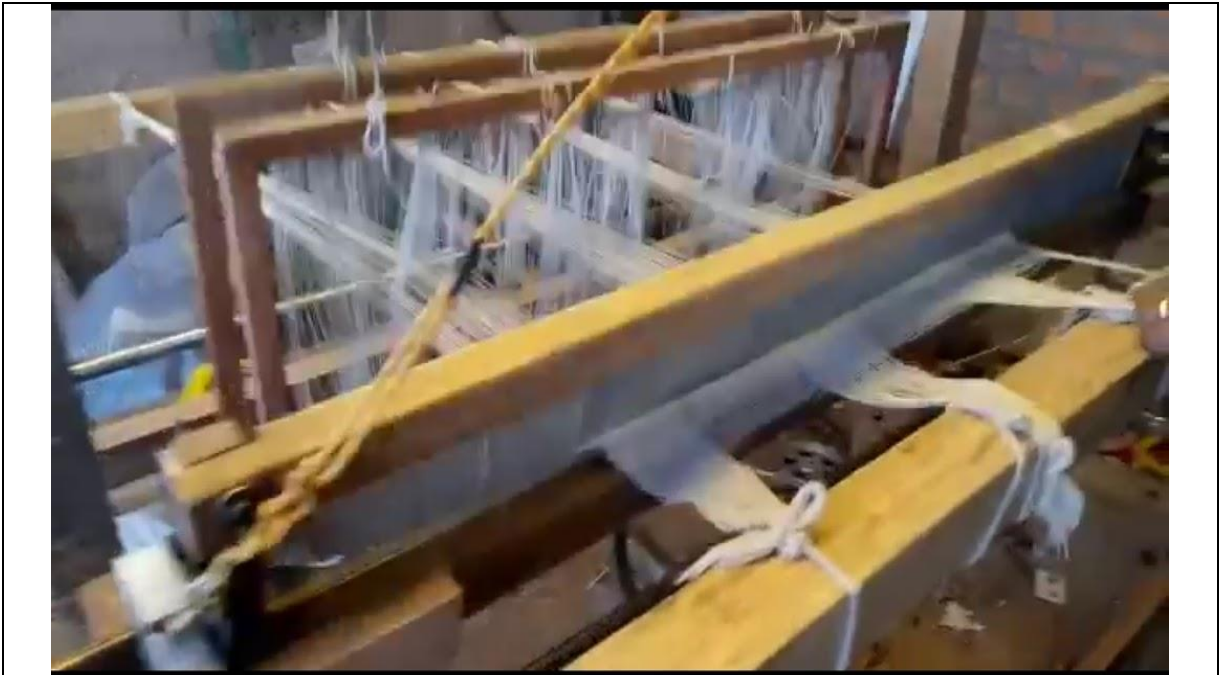
Proceso de prueba del prototipo de telar artesanal automatizado
