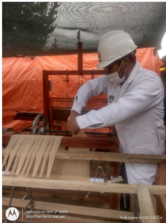
Proceso de traslado de los hilos de urdimbre al telar
