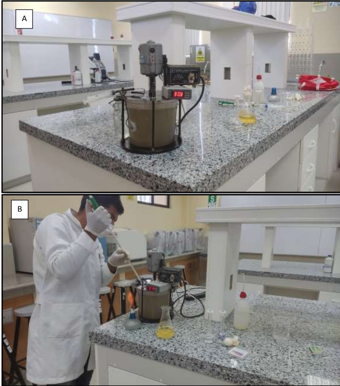
Figura 27. Análisis de DBO 5 y cálculo de eficiencia de reducción de materia orgánica a través del biorreactor. A: Biorreactor en funcionamiento B: inoculación de microorganismos en el biorreactor
