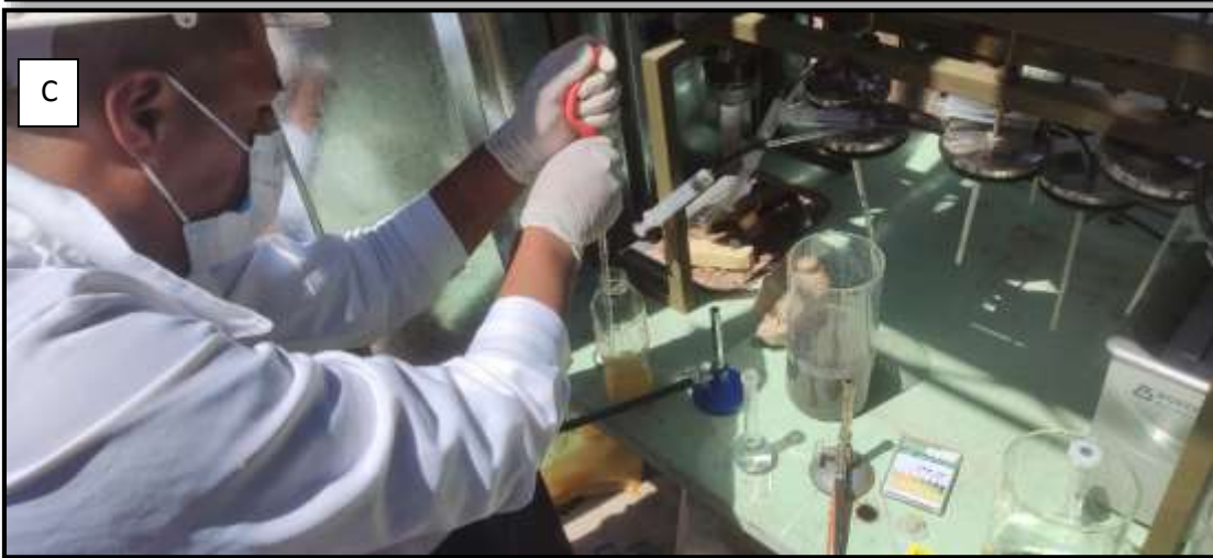
Figura 24. Proceso de biodegradación de materia orgánica A:prototipo de procesos experimentales B: frascos de vidrio de 2L C: inoculación de microorganismos.
