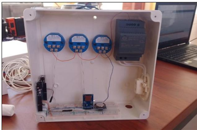
**Figura 24.** Tablero de adquisición de datos de temperatura.
