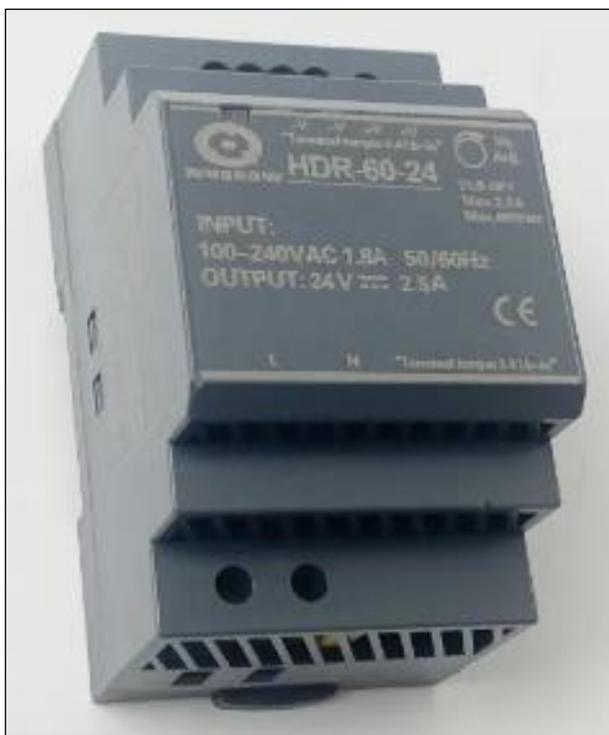
**Figura 18.** Fuente de 24 V en corriente continua.
