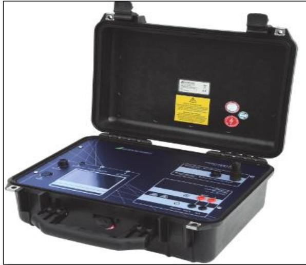
**Figura 14.** Trazador de curva I-V Gossen Metrawatt.
