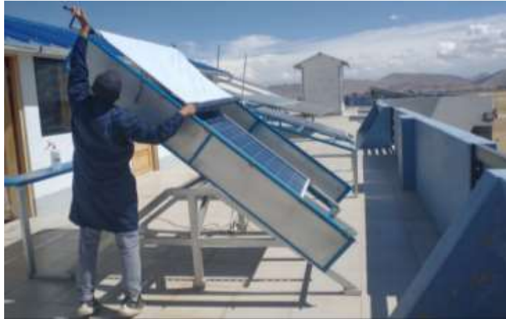
Figura 78. Deslizamiento de la cubierta para el sistema Post- acondicionamiento para controlar mejor la temperatura.
