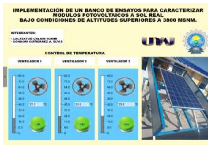
Figura 50. Interfaz HMI del PLC logo 8 desarrollador para visualizar los valores de la temperatura en tiempo real, donde se puede seleccionar el ventilador a operar en el enfriamiento del módulo fotovoltaico.
