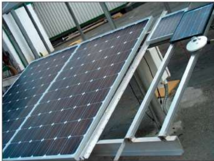
Figura 5. Prueba de módulo fotovoltaico, pre-acondicionamiento (Mocelin, 2014).
