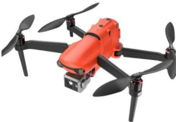
Figura 37. Drone cámara termográfica FLIR Boson 640×512 de resolución térmica (AUTEL ROBOTICS, 2022).
