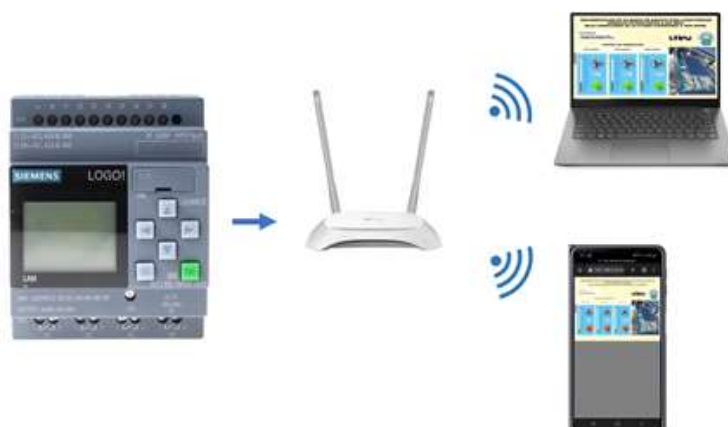
Figura 48. Conexión inalámbrica con la interfaz HMI del PLC logo 8.
