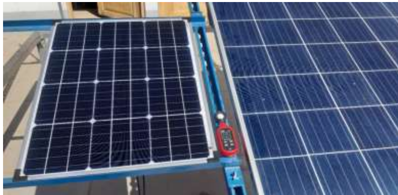
Figura 60. Módulo fotovoltaico TPS-10S-55W en pre-acondicionamiento donde se utiliza un luxómetro que indica una medida mayor a los 1000 lux.
