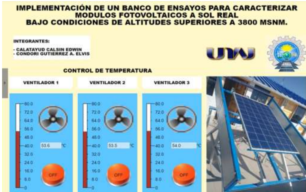
Figura 74. Temperatura de 54 °C obtenida en tiempo real, para comparar los datos de los sensores con los datos de la cámara termográfica.
