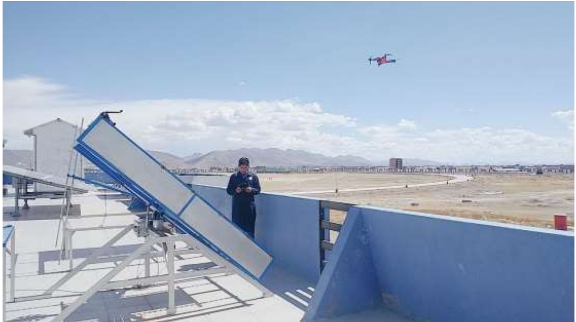
Figura A.7. Realización de prueba con el Drone termográfico a una distancia aproximada de 3 metros y un ángulo de 35 °C.
