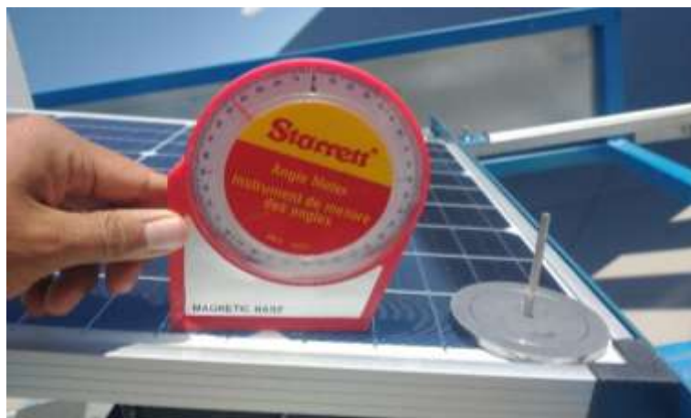
Figura 66. Colocación de altura solar según ángulo correspondiente a la hora para realización de la prueba.
