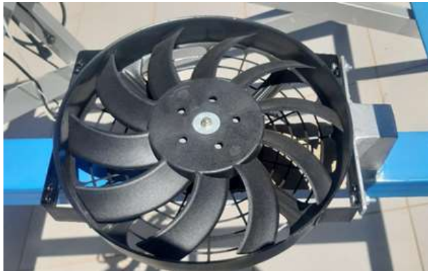
Figura 44. Ventilador de 30 W sujetado en la estructura.
