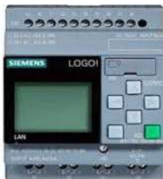
Figura 30. Controlador lógico programable Logo 8 (SIEMENS, 2018).
