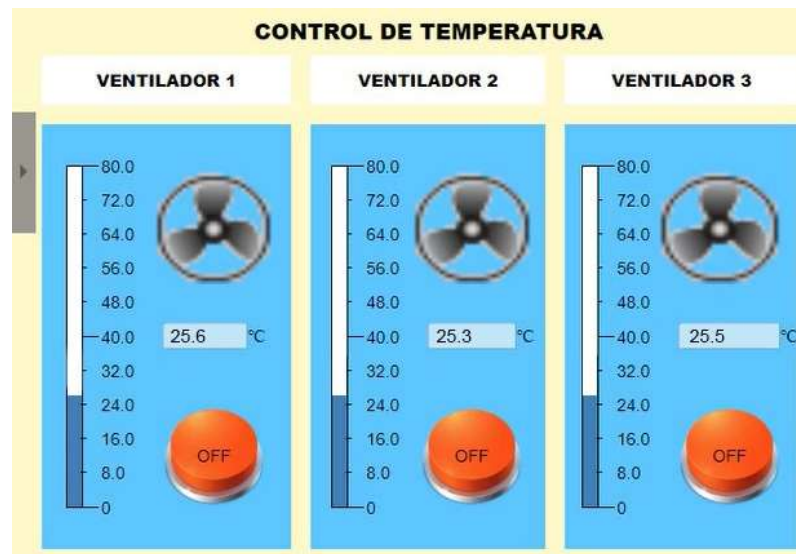
Figura 81. Temperatura registrada por los sensores de la temperatura, donde nos muestra que las temperaturas vuelven homogenizar en todo el módulo fotovoltaico.
