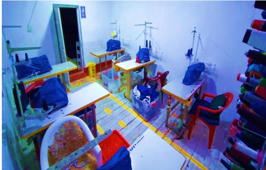
*Figura 25: Área de ensamble y costura después de la aplicación de 5S*
