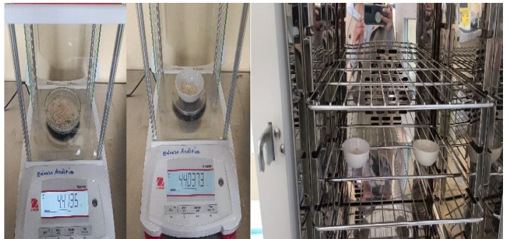
Acondicionando el porcentaje de humedad de la mezcla para la determinación de la ecuación mediante la tendencia lineal
