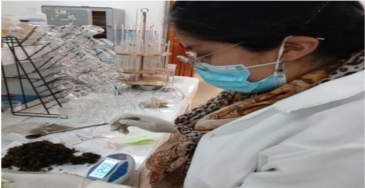
Figura 24. Haciendo pesaje de muestras de biomasa aérea en el laboratorio de suelos y aguas de la facultad de ciencias agrarias en la UNA-Puno.
