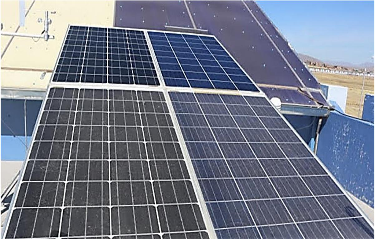
*Figura 48.* Sistemas fotovoltaicos de ambas tecnologías en la parte superior con limpieza y en la inferior expuestos al polvo – estación seca, 18 de Julio del 2023
