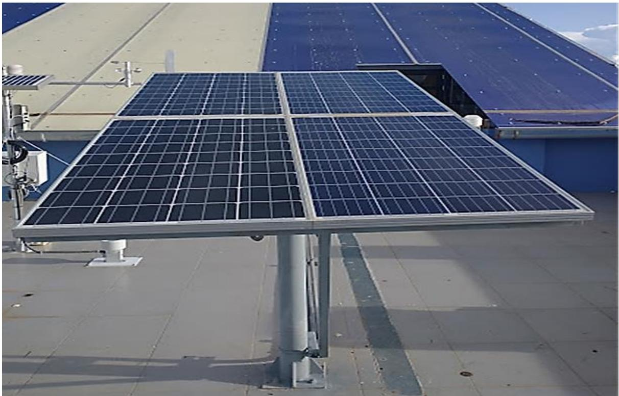
*Figura 47.* Sistemas fotovoltaicos de ambas tecnologías en la parte superior con limpieza y en la inferior expuestos al polvo – estación seca, 22 de junio del 2023
