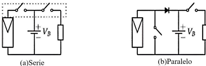
Figura 6. Esquema eléctrico de un regulador de carga
