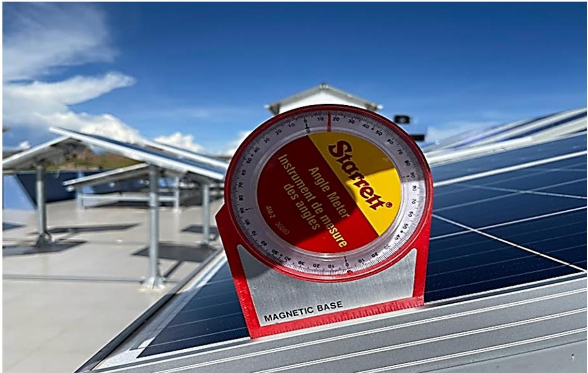
Figura 50. Inclinación de los sistemas fotovoltaicos a 15° con orientación norte
