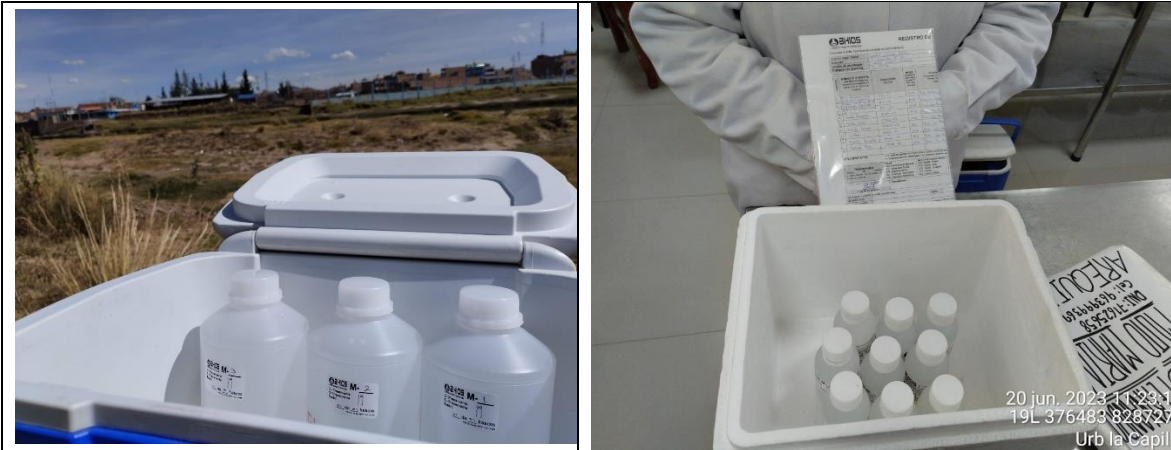
Imagen 25. Muestreo para metales pesados y el respectivo envío al BHIOS laboratorio
