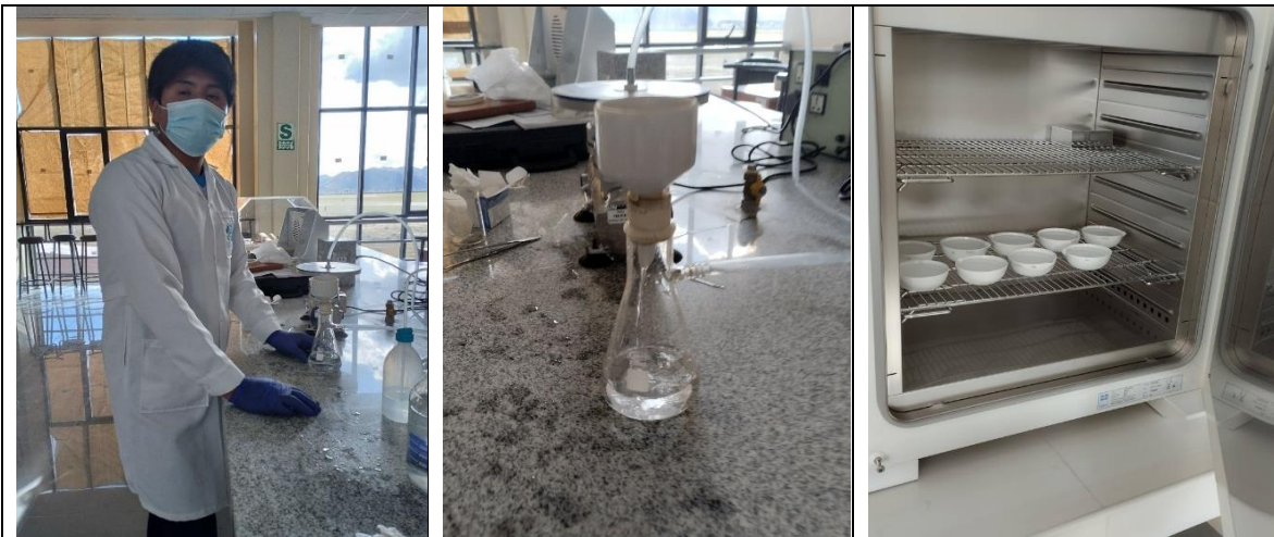
Imagen 8. Análisis del parámetro SDT de la fuente de captación
