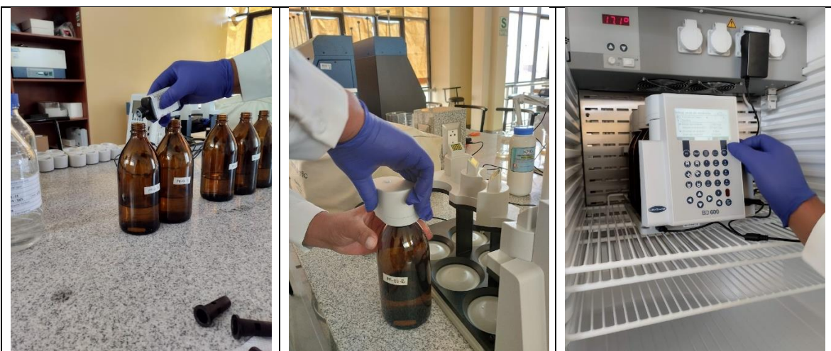
Imagen 9. Análisis del parámetro DBO5 de la fuente de captación
