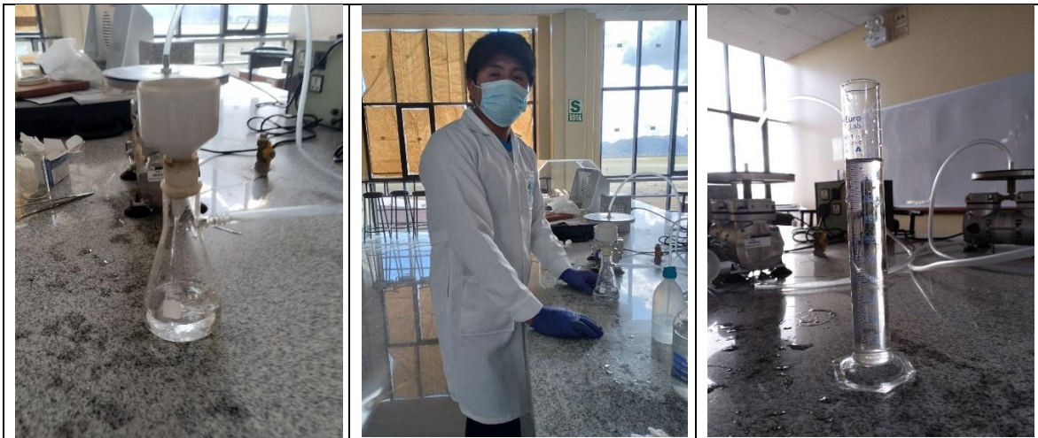
Imagen 10. Análisis del parámetro SDT de la fuente de captación
