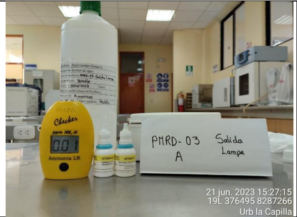
Imagen 28. Análisis de parámetros fisicoquímicos del agua potable
